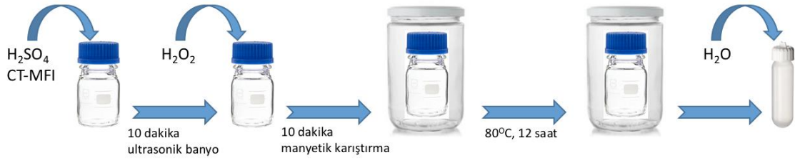
Şekil 4.8 Pirana işleminin şematik gösterimi
