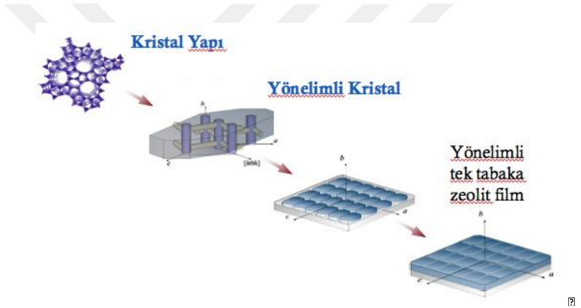
Şekil 4.10 İkincil büyütme metodu ile zeolit membran üretimi (Snyder ve Tsapatsis 2007)
