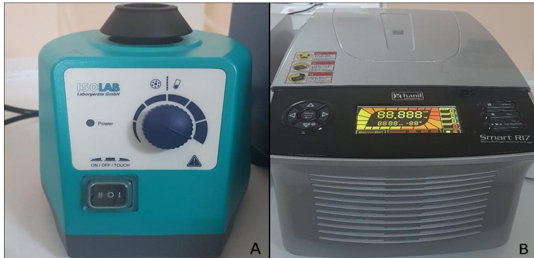
řekil 13: A: Vortex cihazı (Isolab Vortex Shaker ® , Almanya), B: Santrifüj cihazı (Hanil Smart R17 ® )
