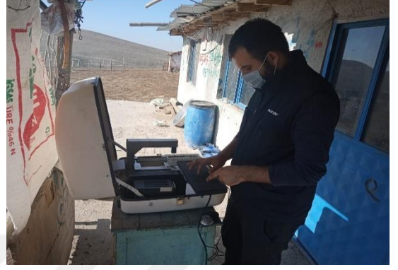
Şekil 6. Tiftik numunesi alınması ve OFDA cihazında çalışılması
