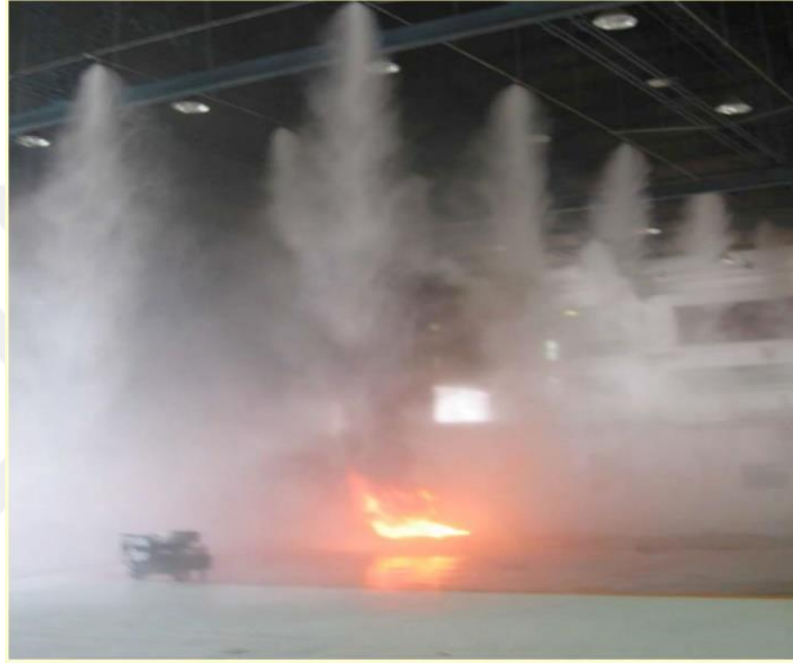
Şekil 2.16. Su sisi (Watermist)
