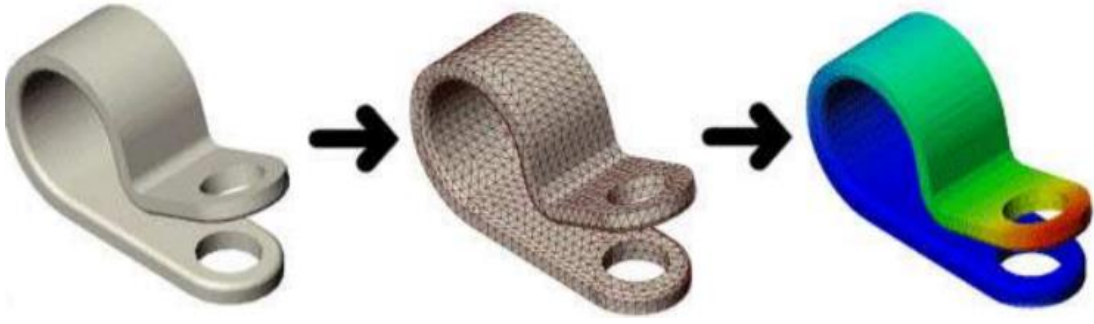
Şekil 4.3. Geometrik model, Sonlu eleman modeli ve sonuçların gösterildiği nodal sonuçlar.
