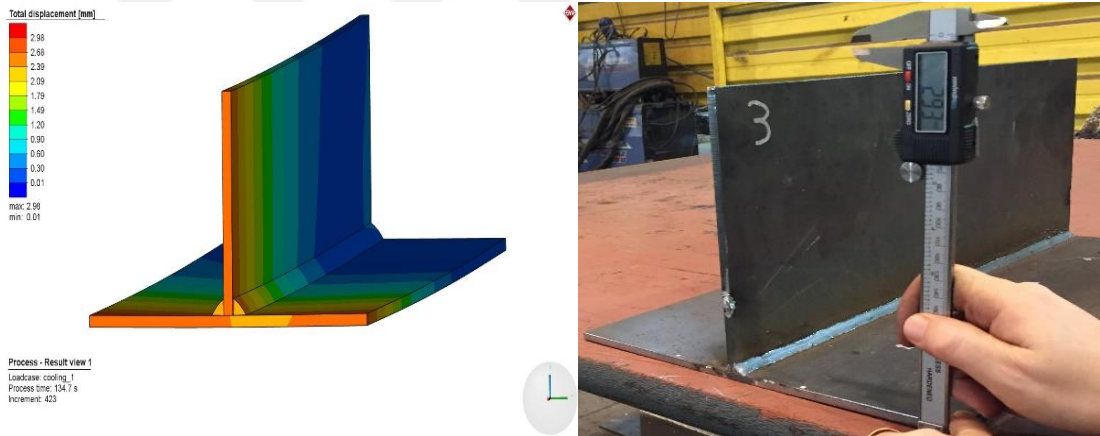
Şekil 7.13. Dikey plaka ve kaynak tarafındaki yatay plakanın kaynak sonrası görülen açısıl çarpılma.
