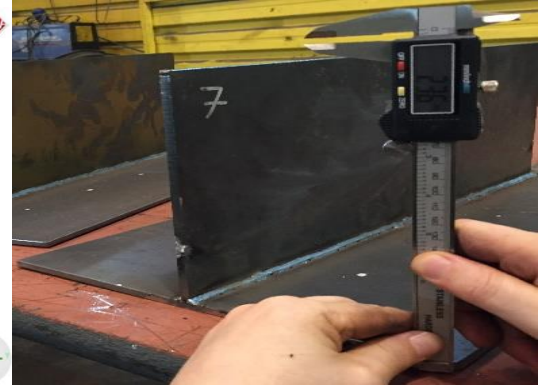
Şekil 7.17. 7 Dikey plaka ve kaynak tarafındaki yatay plakanın kaynak sonrası görülen açısal çarpılma.
