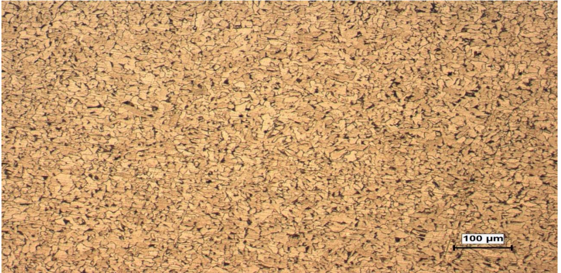
Şekil 7.1. Ana metalin mikroyapı görüntüsü.
