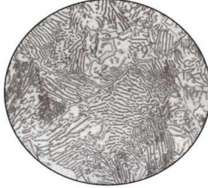
Şekil 2.7. Perlit(% 0.45 C) mikroskop altındaki görüntüsü.
