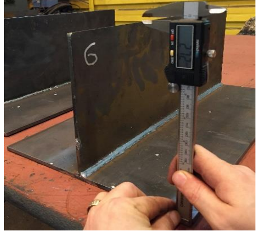
Şekil 7.16. 6 Dikey plaka ve kaynak tarafındaki yatay plakanın kaynak sonrası görülen açısal çarpılma.
