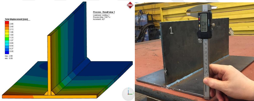
Şekil 7.11. 1 Dikey plaka ve kaynak tarafındaki yatay plakanın kaynak sonrası görülen açısal çarpılma.
