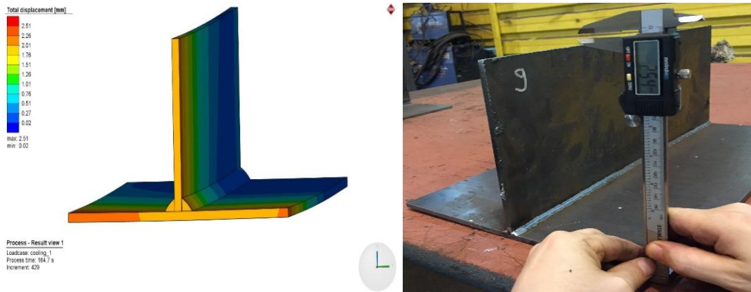
Şekil 7.19. 9 Dikey plaka ve kaynak tarafındaki yatay plakanın kaynak sonrası görülen açısıl çarpılma.
