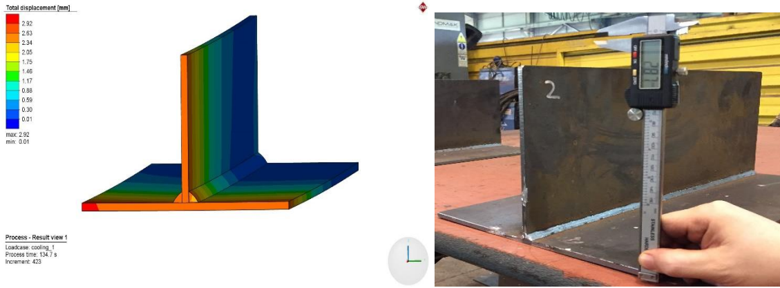
Şekil 7.12. 2 Dikey plaka ve kaynak tarafındaki yatay plakanın kaynak sonrası görülen açısıl çarpılma.
