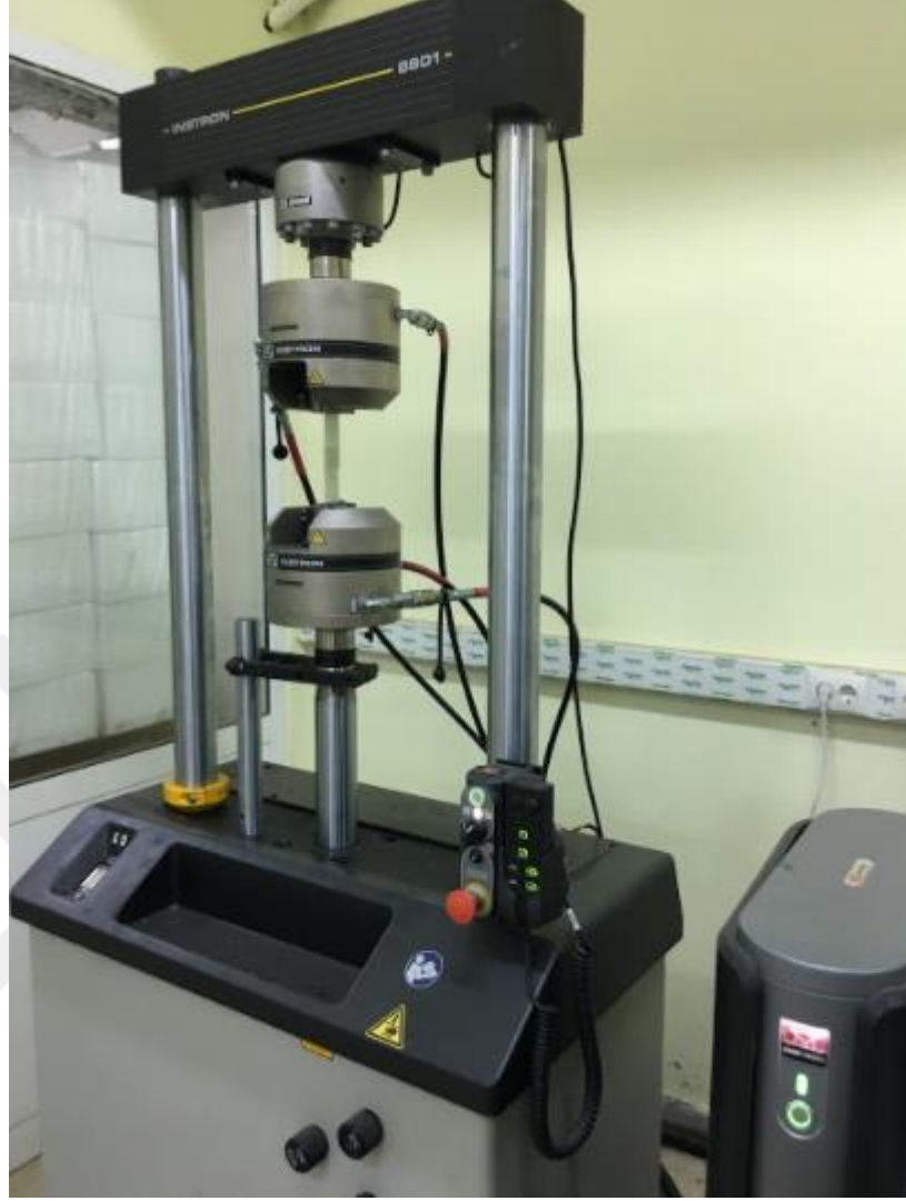
Şekil 4.8. Çekme test cihazı ve deney düzeneği
