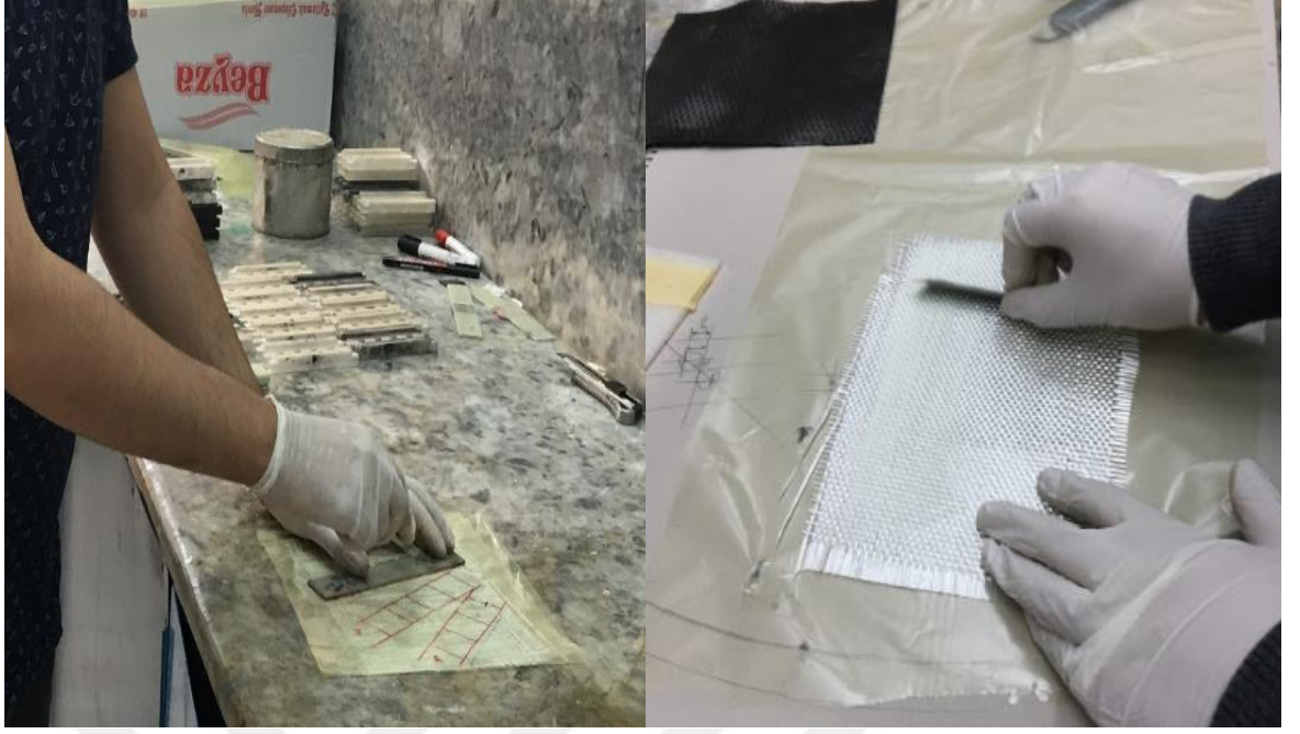
Şekil 4.5. Hazırlanan kalıplar ve yapıştırıcıyla ıslatılmış cam fiber kumaş kuponlarının kesilme işlemi
