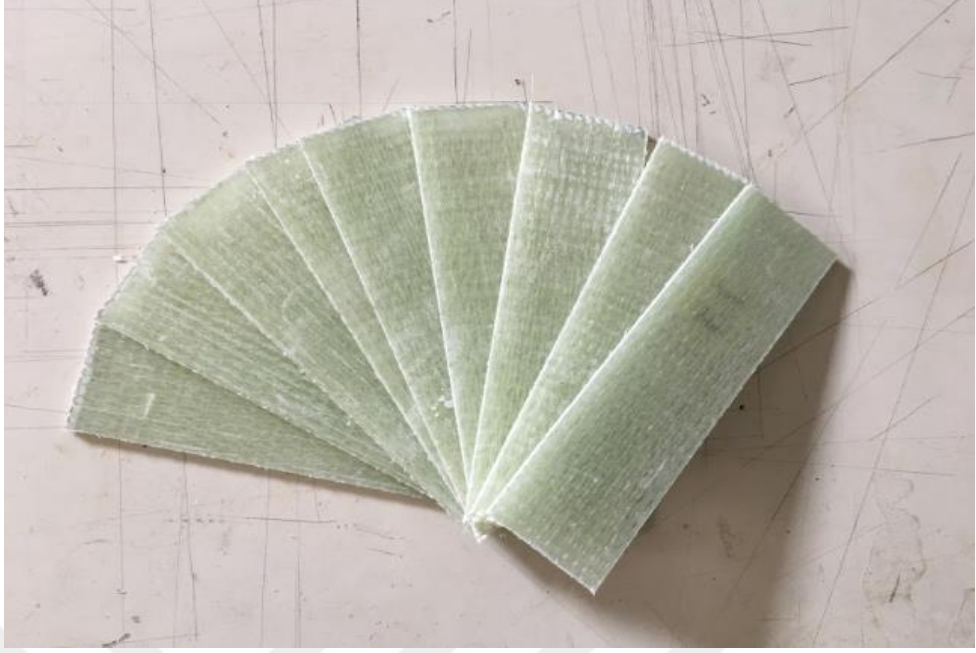
Şekil 4.2. Deney numuneleri için kesilen kompozit levhalar
