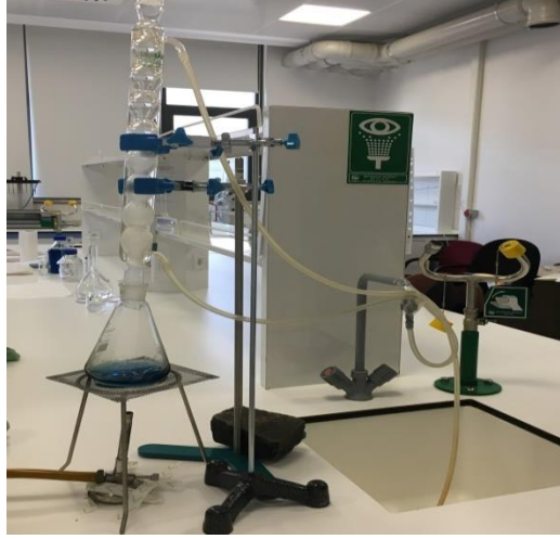
Şekil 3.4. Luff-Schoorlyöntemi ile yapılan şeker analizi
