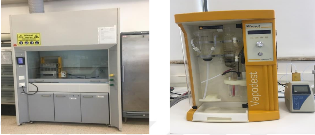
Şekil 3.5. Protein analizi için kullanılan çeker ocak ve titrasyon düzeneği
