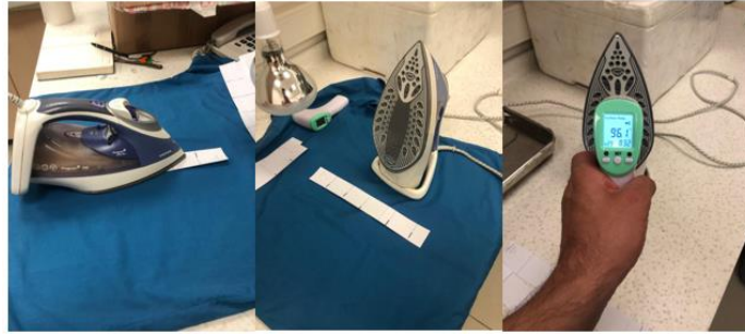
Şekil 4.4. Ütünün sıcaklık ölçümü ve yapay yaşlandırma aşamaları.
