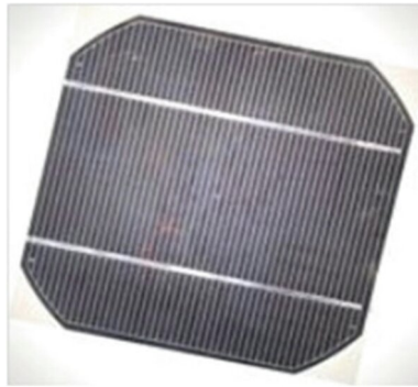
Şekil 2.6 Tek kristal yapılı PV panel hücresi (Mohanty, 2016).
