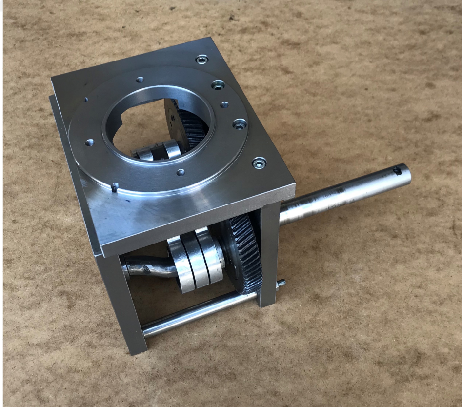
Resim 5.14. Rhombic hareket iletim mekanizmasının montaj görüntüsü
