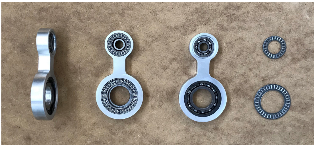
Resim 5.27. Biyel kollarının rulmanlı montaj görüntüsü
