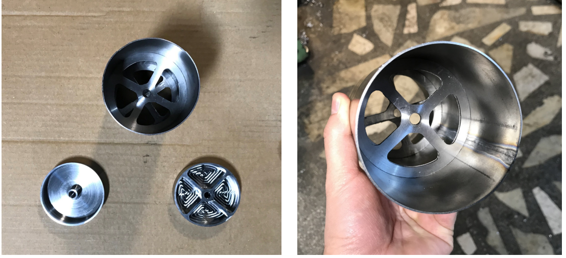
Resim 5.23. Ti 6Al 4 V (GR5 titanyum) malzemedan imalatı gerçekleştirilen yeni yer değiştirme pistonunun iç görünümü
