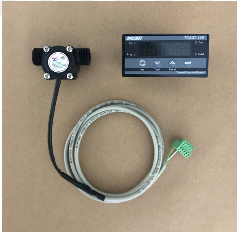
Resim 5.34. VFA marka M1 serisi türbin tip debimetre ve EMKS TCS37-100 model dijital sayıcı sensör
