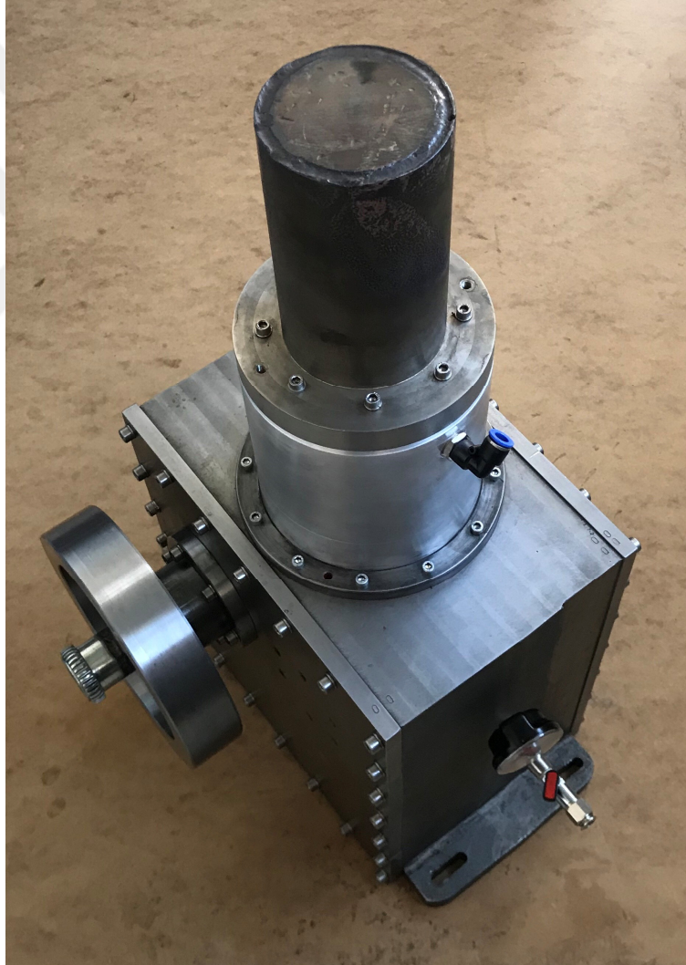
Resim 5.8. İmalatı gerçekleştirilen rhombic hareket iletim mekanizmalı Stirling motorunun montaj görüntüsü
