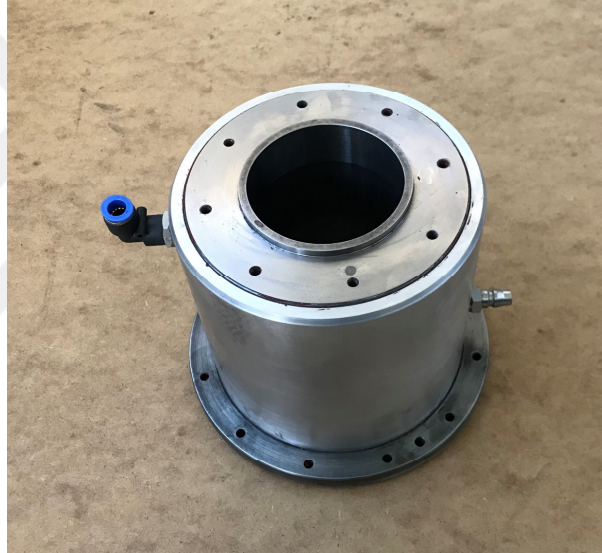
Resim 5.18. Güç silindiri ve soğutucu gömleğin montaj görüntüsü
