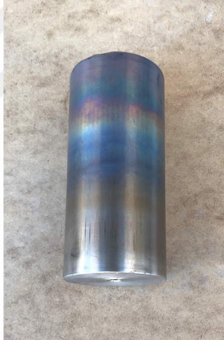
Resim 5.24. Ti 6Al 4 V (GR5 titanyum) malzemedan imalatı gerçekleştirilen yer değiştirme pistonu
