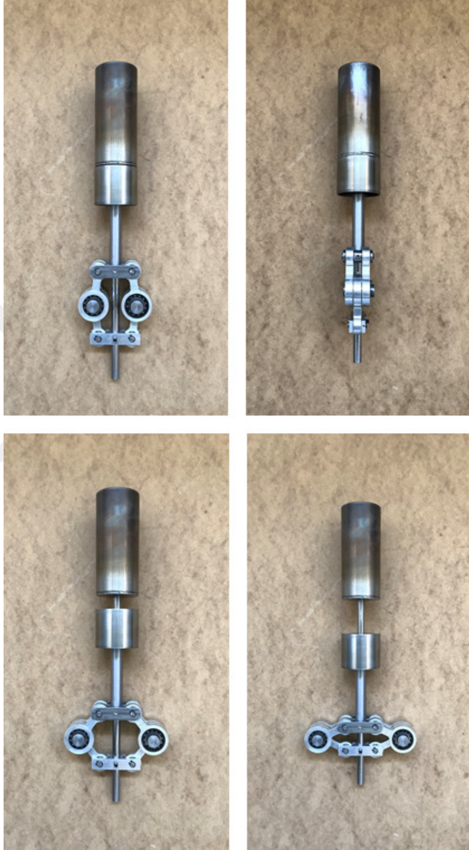
Resim 5.9. İmalatı gerçekleştirilen rhombic hareket iletim mekanizması ve pistonların montaj görüntüsü
