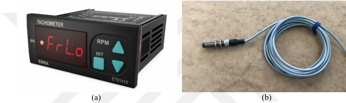
Resim 5.32. ETS1410 dijital takometre ve Schneider endüktif sensör
