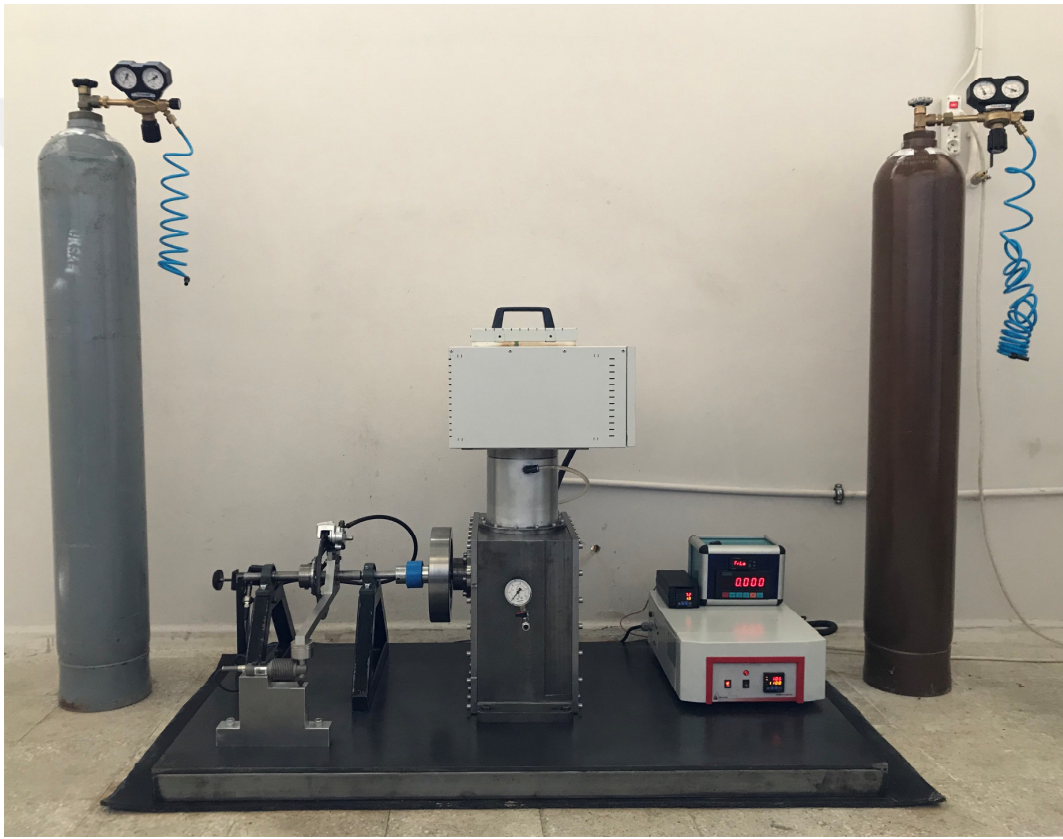
Resim 5.29. İmalatı gerçekleştirilen rhombic hareket iletim mekanizmalı Stirling motorunun deney düzeneği
