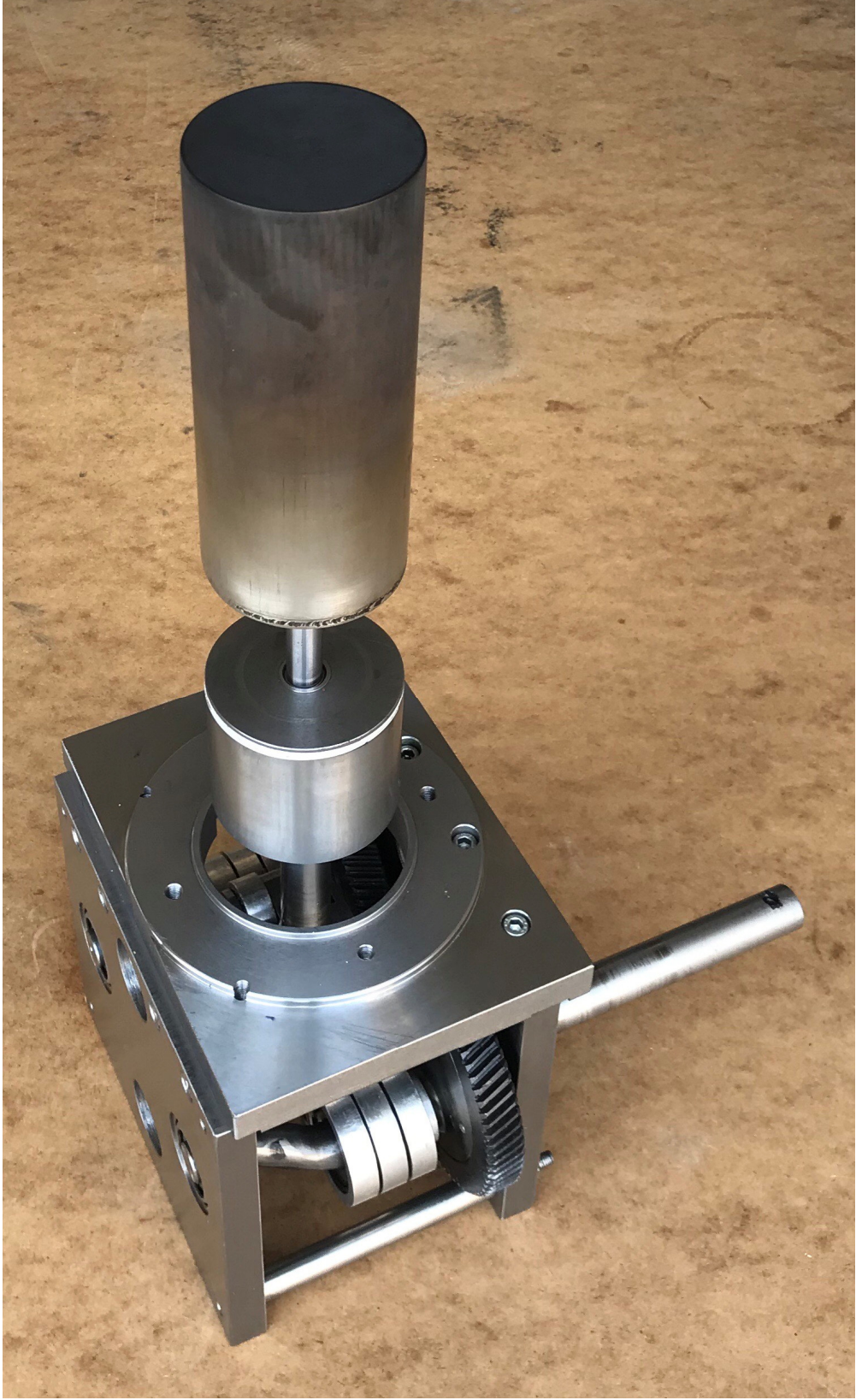
Resim 5.15. Rhombic hareket iletim mekanizması ve pistonların montaj görüntüsü
