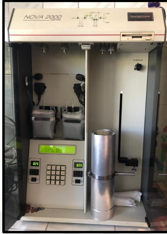
Şekil 3.4 Ouantachrome Nova 2200 serisi volumetrik gaz adsorpsiyon cihazı
