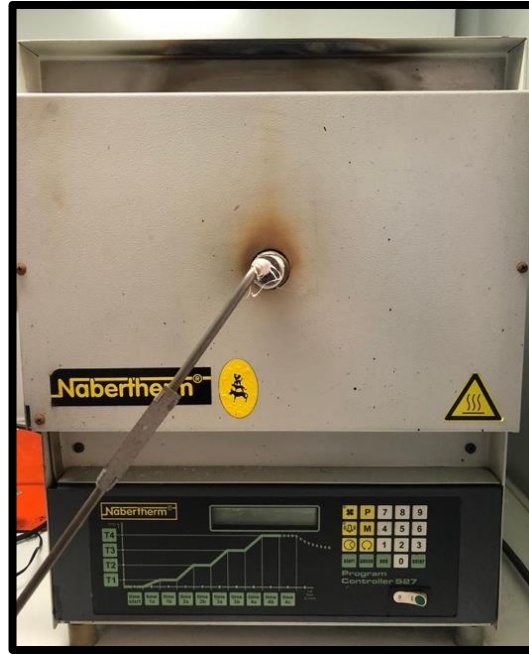
řekil 3.2 Karbonizasyon iřleminin gerekleřtirildiđi sıcaklık programlı ısıl iřlem fırını
