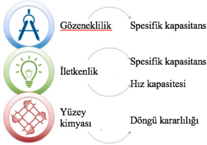
Şekil 2.6 Elektrot malzemesinin özellikleri ve kapasitörün performansı arasındaki etkileşim (Conder vd 2019)
