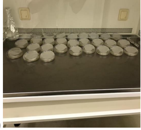
Şekil 3.2. Kültür ortamı hazırlıkları a) Ortam oluşturulması için gerekli malzemelerin ön hazırlığı b) Ortam oluşturulduktan sonra steril kabinde petrilere dökülerek katılaşmasının sağlanması.
