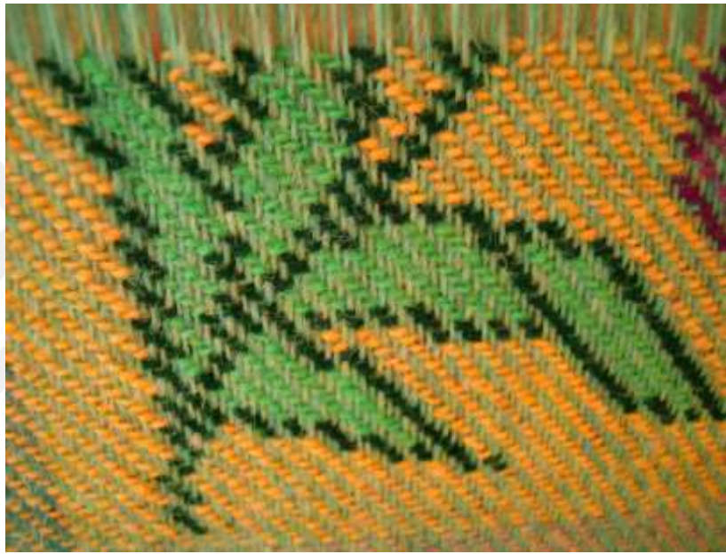
Şekil 5: (twill tapestry) olarak adlandırılmış dimi tekniğindeki dokuma resim örneğinin yapım sırasındaki görünümü
