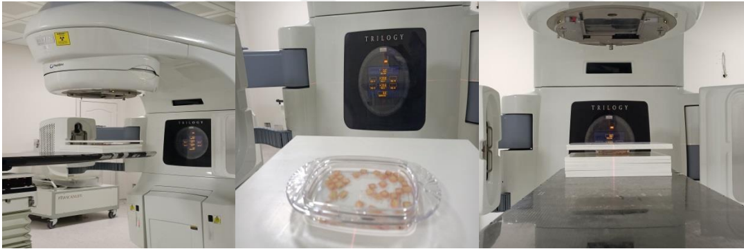
Şekil 3.1. Lineer akselator cihazı (Varian Trilogy, Varian Medical Systems, Palo Alto, CA) ve mine örneklerinin ışınlama uygulaması
