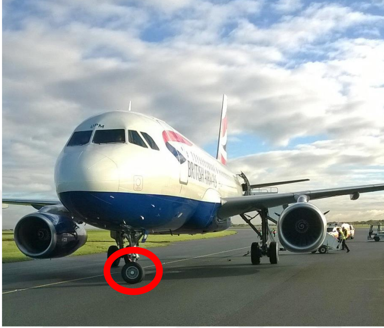
Şekil 3.3 : Airbus A319'a ait NLG'nin shimmye mazur kaldıktan sonraki pozisyonu.
