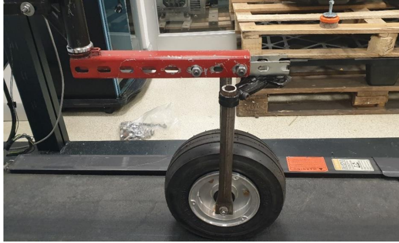
Şekil 5.4 : Tekerlek/lastik yapısı ve değiştirilebilir kaster uzunluğu.
