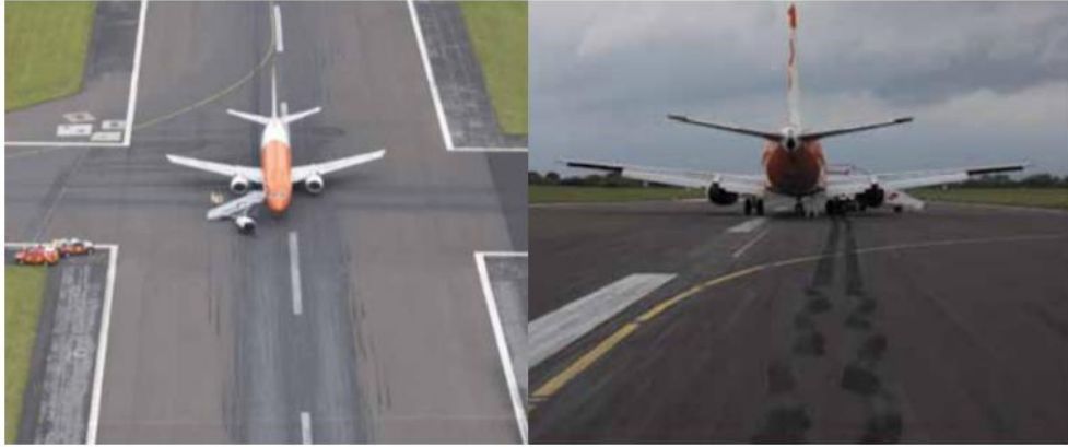
Şekil 3.2 : Shimmy etkisi altındaki Boeing 737 uçağının pistte durduğu nokta ve pist üzerindeki tekerlek izleri.
