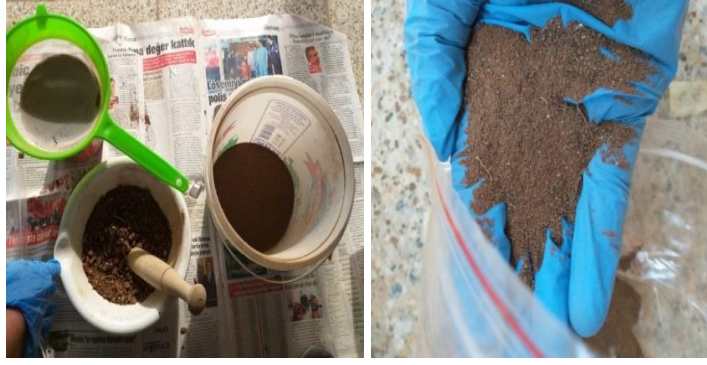
Şekil 3.4. Element analizleri için toprağın elenmesi ve poşetlenmesi
