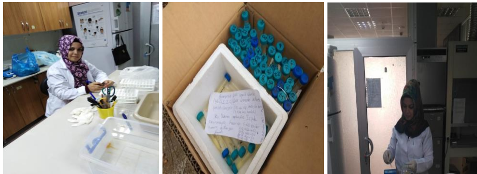
Şekil 3.6. Bezelye yapraklarının nitrik asit ile yaş yakma ve polistren tüplere yerleştirilmesi
