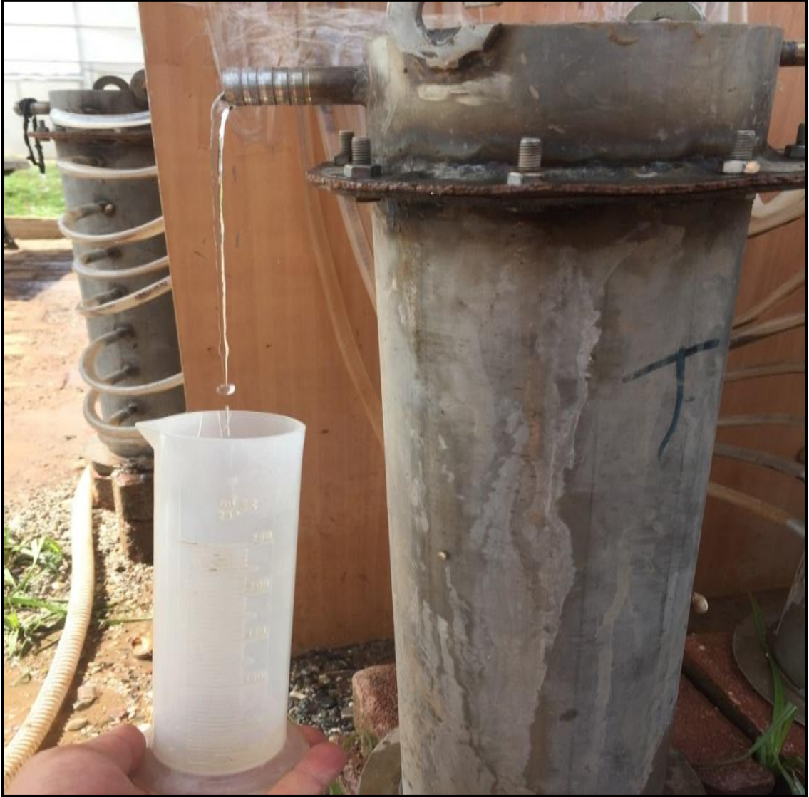
Şekil 3.7. Ölçülü kap yardımı ile debi ölçümünün yapılması
