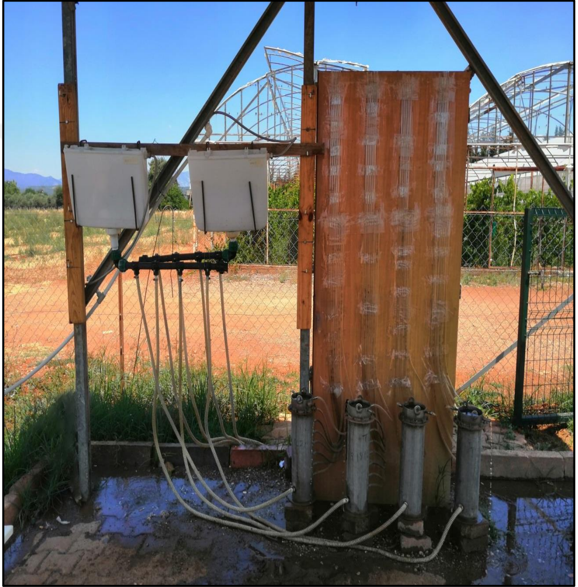
Şekil 3.2. Permeametre düzeneğinin kurulumu ve tesviyesi
