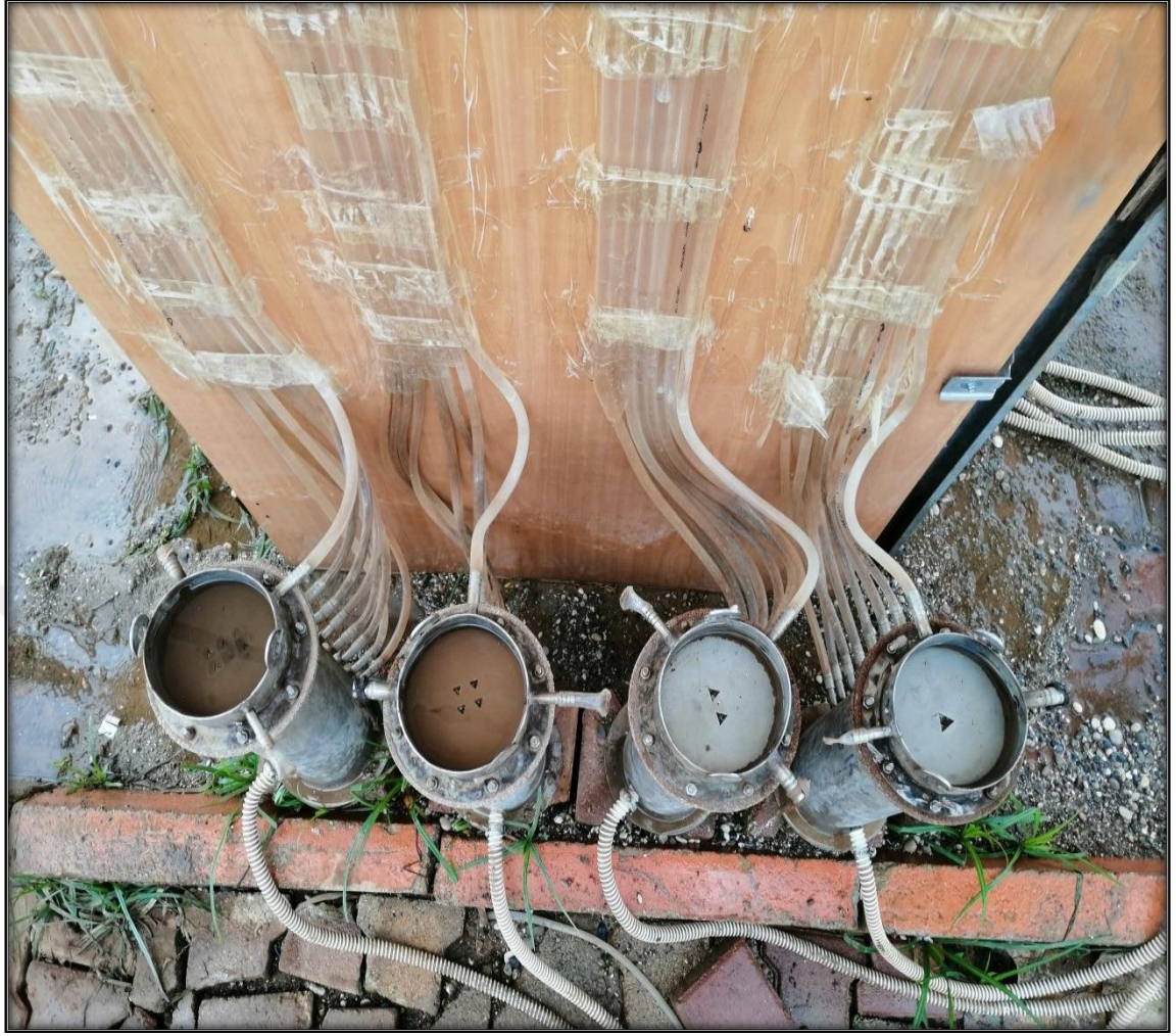
Şekil 3.4. Permeametre düzeneğinde flanşlı vidalı sistemin üstten görünümü
