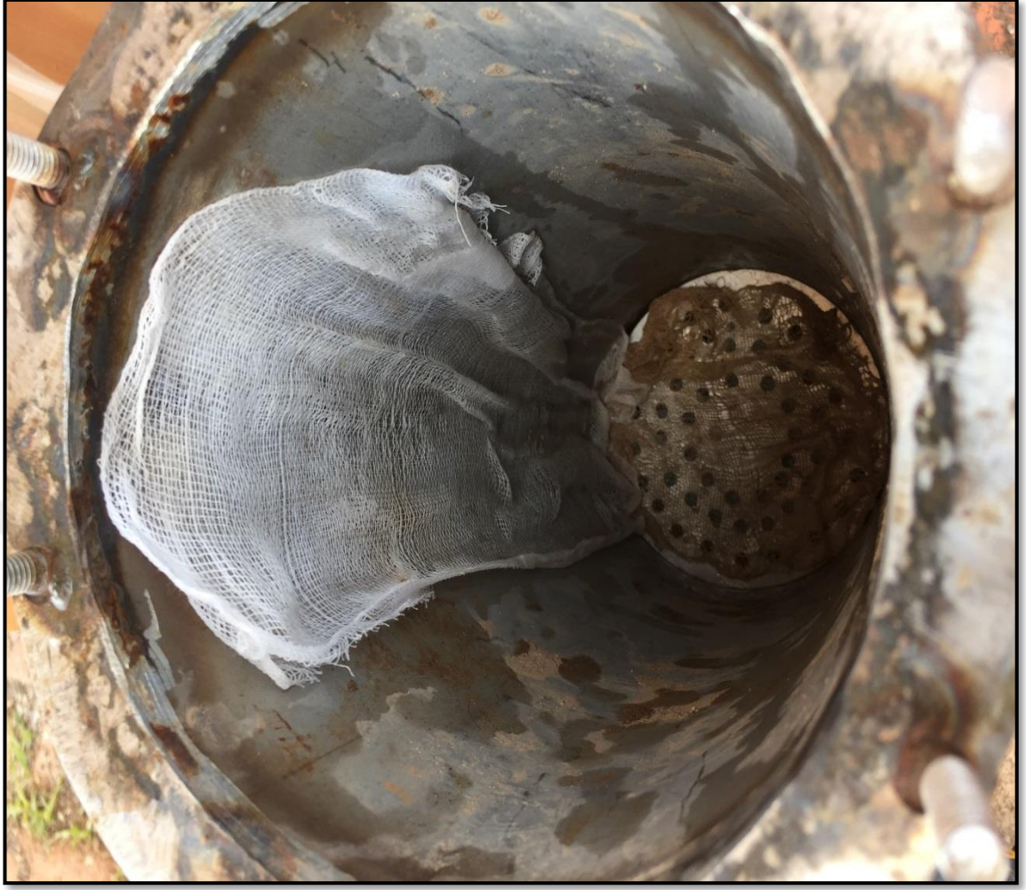
Şekil 3.3. Permeametre düzeneğine toprak zerrelere girişinin önlenmesi
