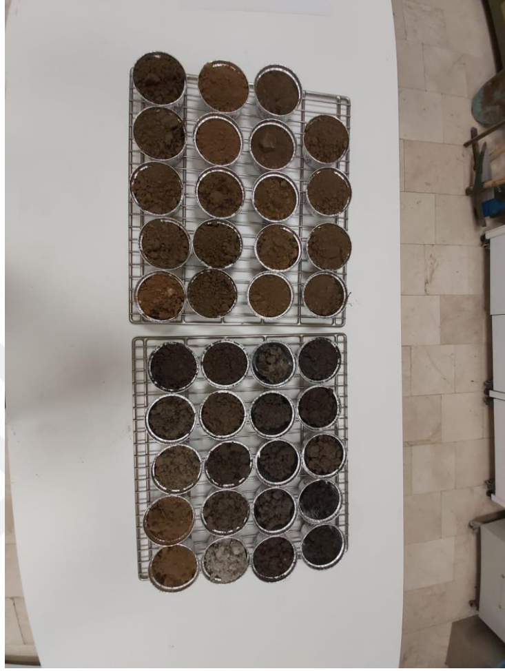
Şekil 2.13 : Toprak örneklerinin etüve yerleştirilmek üzere hazırlanışı.
