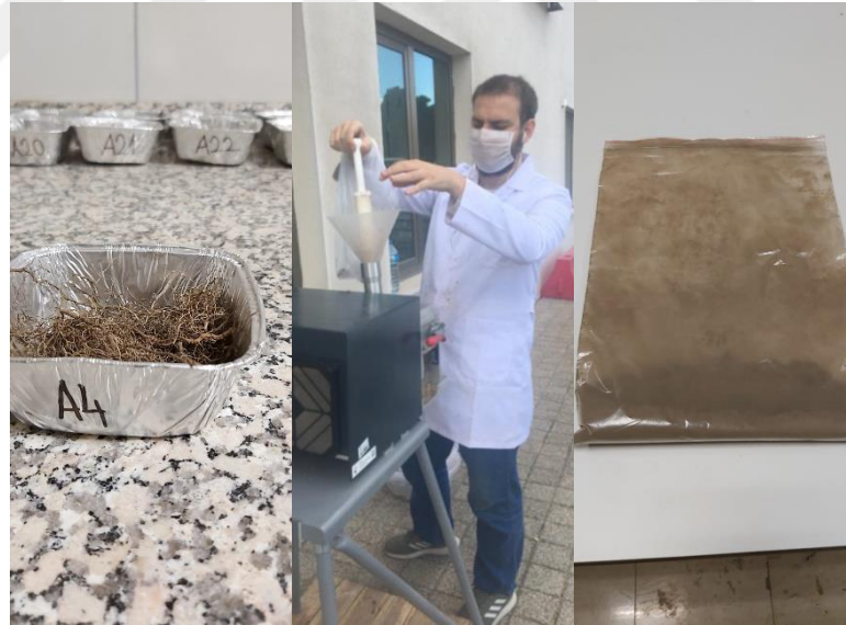
Şekil 2.12 : Kök örneklerinin öğütülmesi işlemi.
