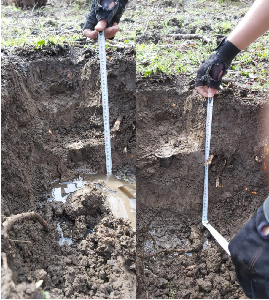
Şekil 2.10 : Horizonlara göre çelik silindir ile toprak örneklerinin alınması.
