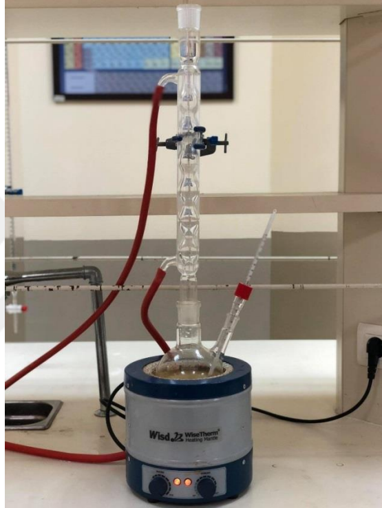
Şekil 3. 2. Asit yağın transesterifikasyonu için kurulan reflux düzeneği
