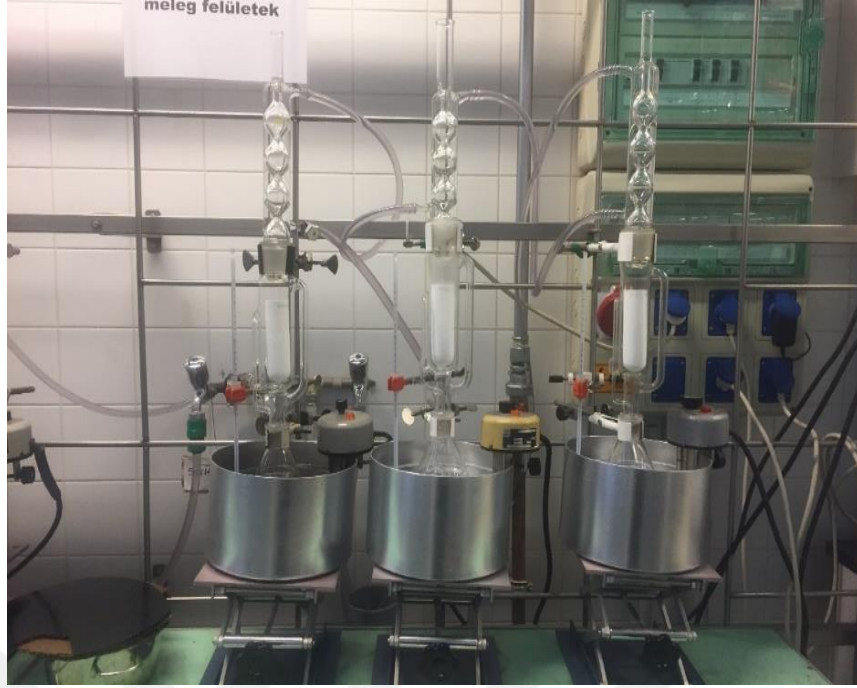
Şekil 4.4 Soxhlet ekstraksiyon yönteminin aşamaları
