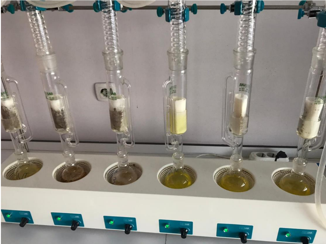
Şekil 3.3. Sokshelet düzeneği ile propolislerde yağ ekstraksiyonu.
