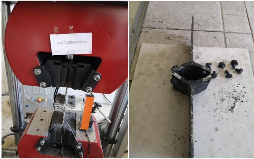
Şekil 3.36. I220-T1000-400 \mu numunesinin çekme deneyi önce ve sonrası durumu.
