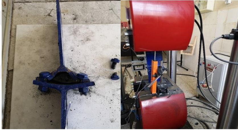
Şekil 3.64. I220 Numunesinin çekme deneyi sonrası durumu.
