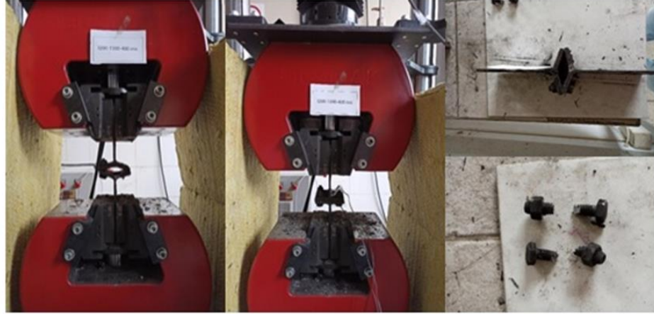
Şekil 3.13. IPE200-T300-400 \mu numunesinin çekme deneyi önce ve sonrası durumu.
