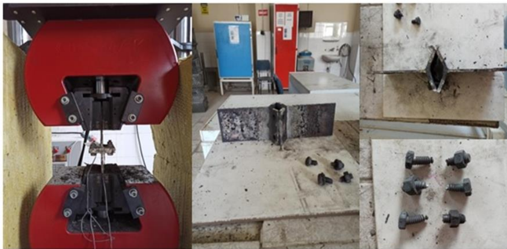
Şekil 3.6. IPE200-T1000 numunesinin çekme deneyi önce ve sonrası durumu.
