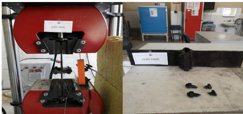
Şekil 3.45. I240-T600 Numunesinin çekme deneyi sonrası durumu.
