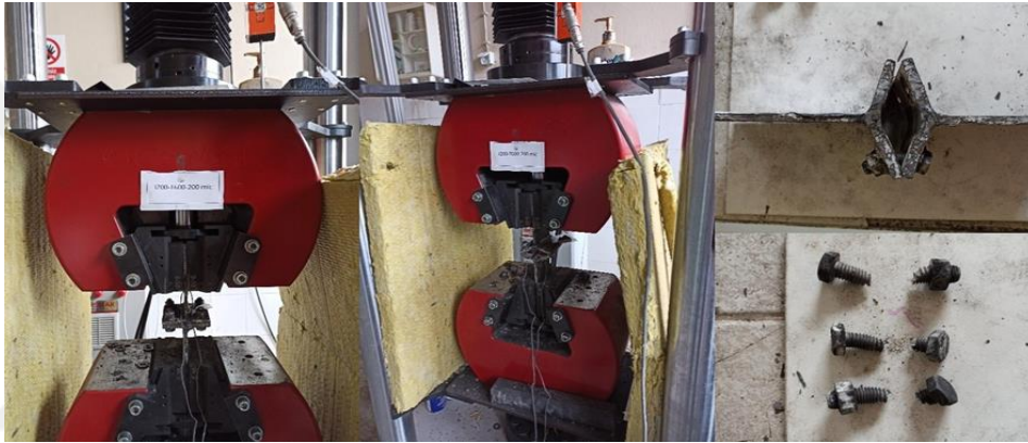
Şekil 3.10. IPE200-T600-200 \mu numunesinin çekme deneyi önce ve sonrası durumu.
