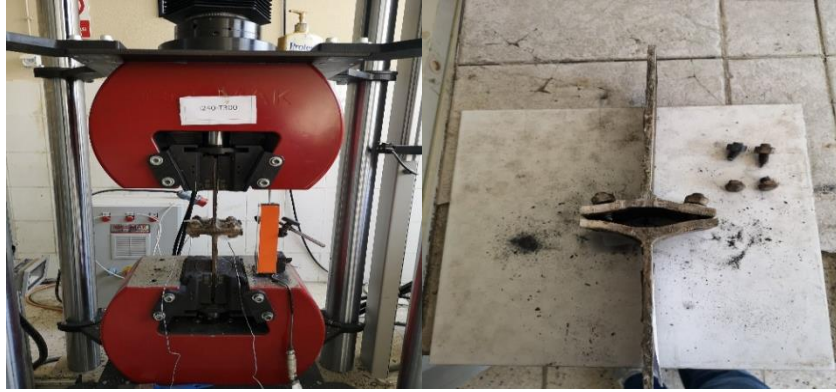
Şekil 3.43. I240-T300 Numunesinin çekme deneyi sonrası durumu.
