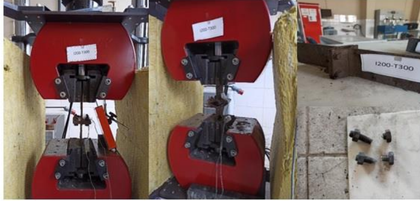
Şekil 3.23. IPE200-T300 numunesinin çekme deneyi önce ve sonrası durumu.
