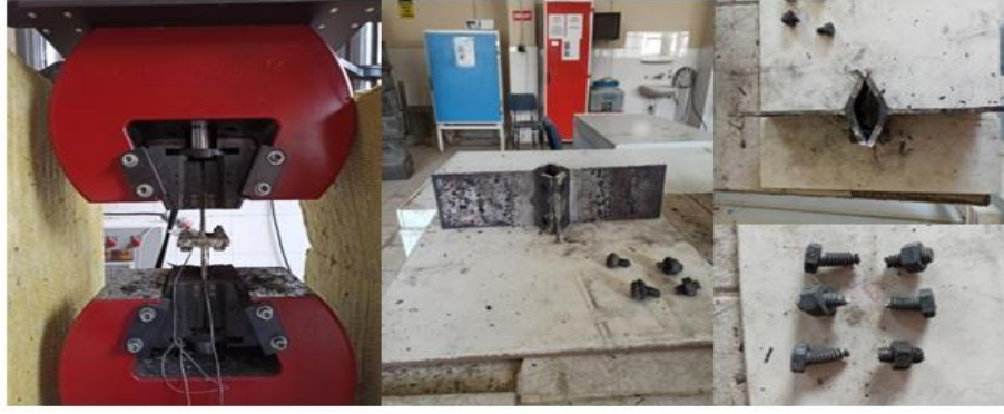
Şekil 3.26. IPE200-T1000 numunesinin çekme deneyi önce ve sonrası durumu.
