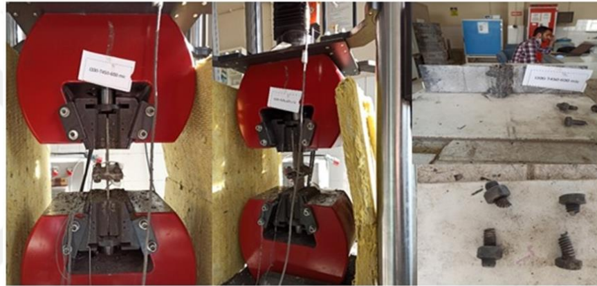
Şekil 3.19. IPE200-T450-600 \mu numunesinin çekme deneyi önce ve sonrası durumu.
