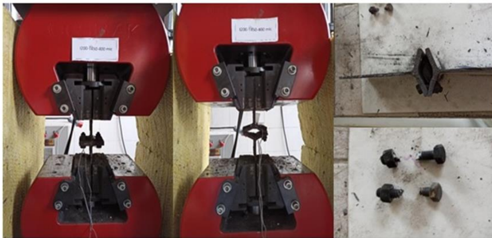
Şekil 3.14. IPE200-T450-400 \mu numunesinin çekme deneyi önce ve sonrası durumu.
