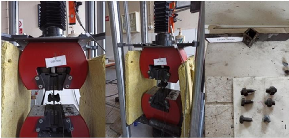
Şekil 3.5. IPE200-T600 numunesinin çekme deneyi önce ve sonrası durumu.
