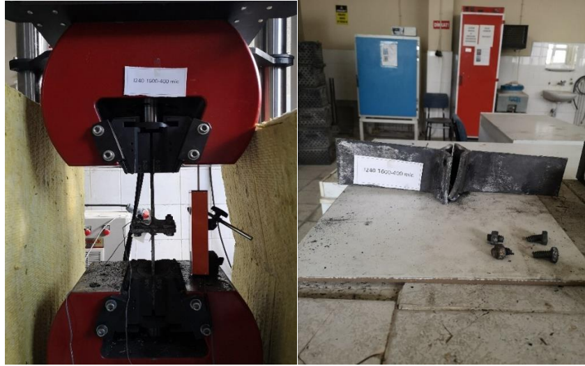
Şekil 3.55. I240-T600-400 \mu numunesinin çekme deneyi önce ve sonrası durumu.
