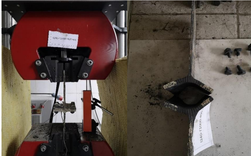
Şekil 3.56. I240-T1000-400 \mu numunesinin çekme deneyi önce ve sonrası durumu.
