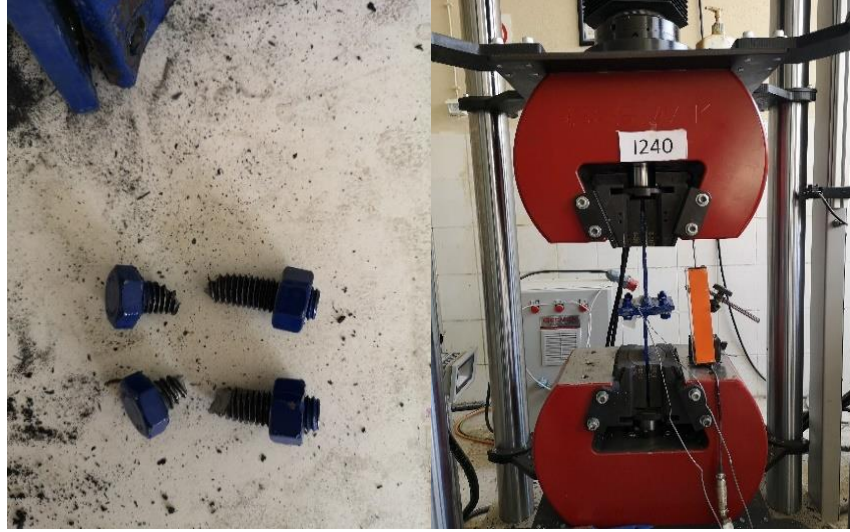
Şekil 3.65. I240 Numunesinin çekme deneyi sonrası durumu.
