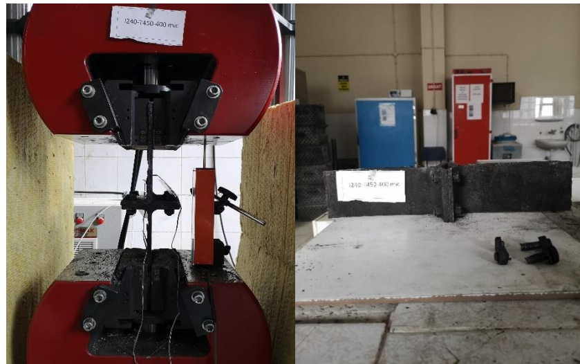
Şekil 3.54. I240-T450-400 \mu numunesinin çekme deneyi önce ve sonrası durumu.
