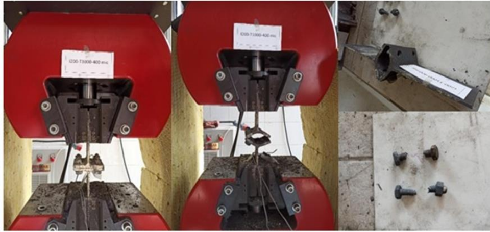
Şekil 3.16. IPE200-T1000-400 \mu numunesinin çekme deneyi önce ve sonrası durumu.
