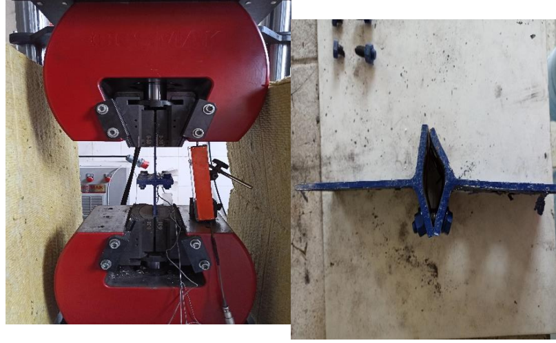
Şekil 3.63. I200 Numunesinin çekme deneyi sonrası durumu.
