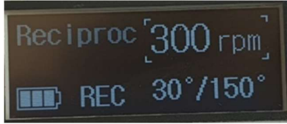
Şekil 3.7. Resiprokal rotasyon hareketinin kullanım ayarları.
