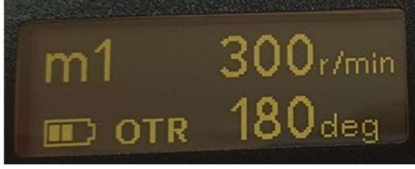
Şekil 3.9. OTR 180° hareketinin kullanım ayarları.
