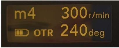
Şekil 3.10. OTR 240° hareketinin kullanım ayarları.
