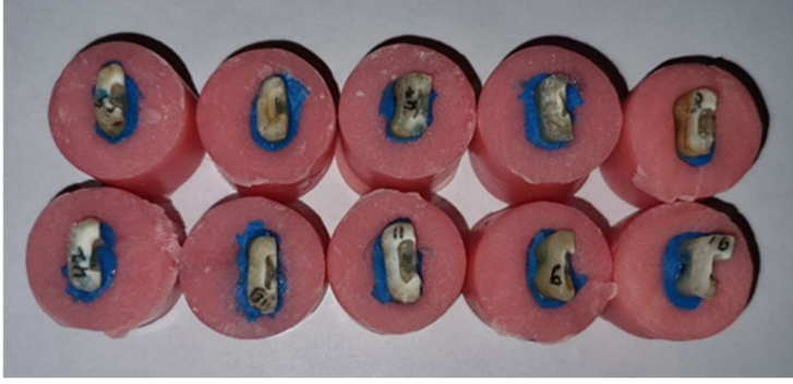
Şekil 3.5. Periodontal ligament ve çevre kemik dokunun in-vitro olarak taklidi amacıyla oluşturulan deney düzeneği.
