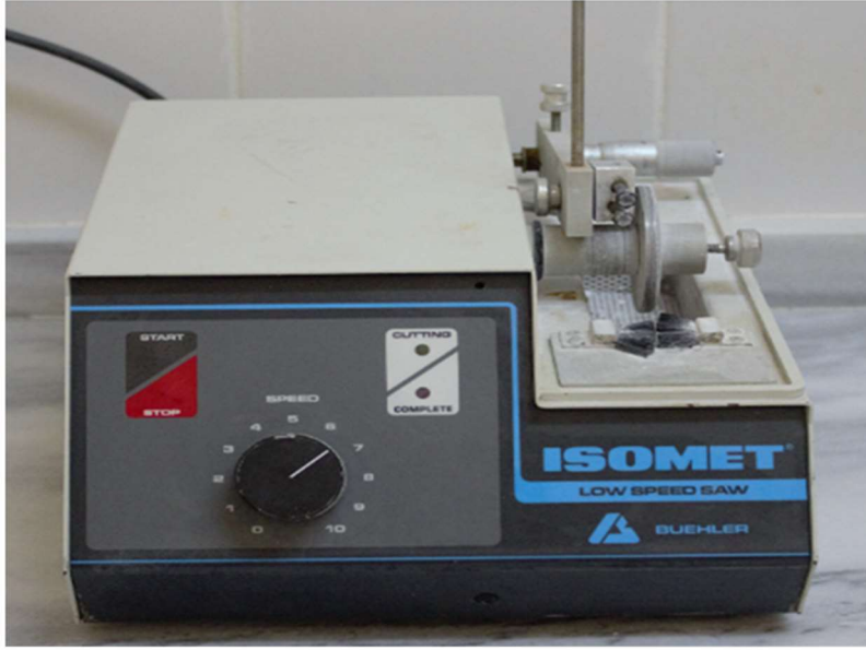
Şekil 3.15. Örneklerden horizontal kesitler almak için kullanılan isomet cihazı.
