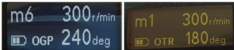
Şekil 3.13. OGP 240° + OTR 180° hareketinin kullanım ayarları.
