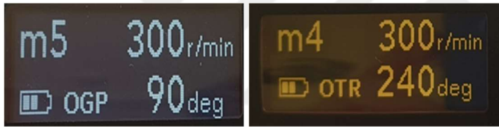
Şekil 3.12. OGP 90° + OTR 240° hareketinin kullanım ayarları
