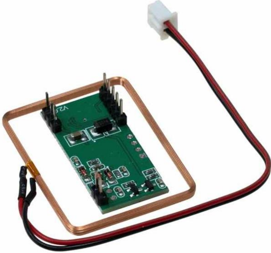
Şekil 6.4. Akıllı prizde kullanılan etiket okuyucu [16].
