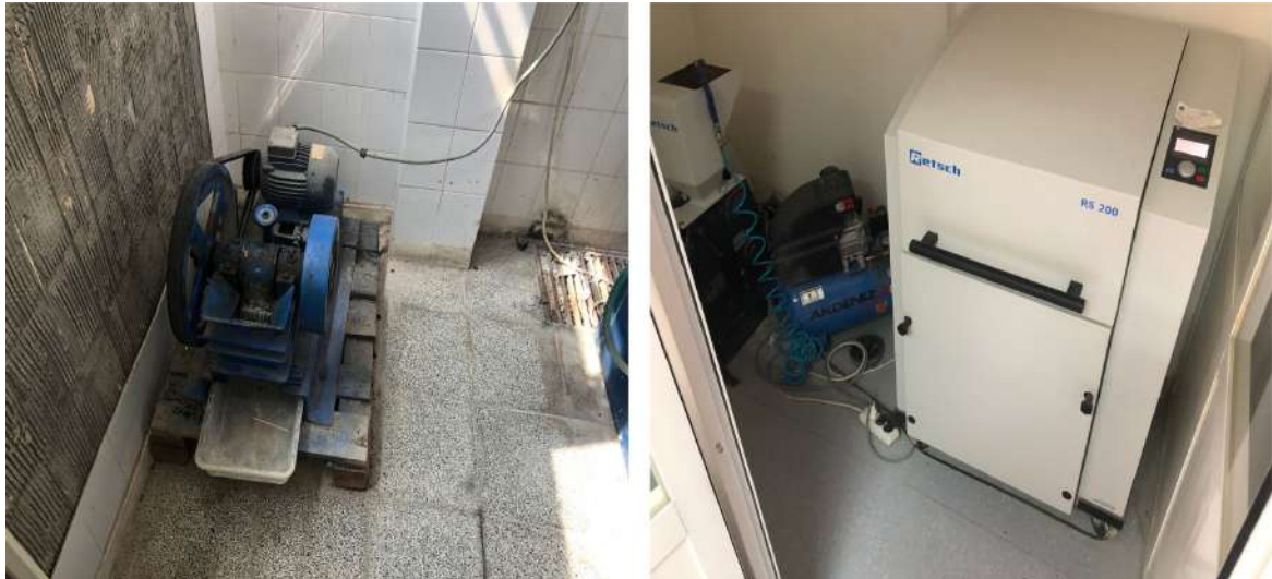
Şekil 3.2. Kırma ve öğütme işlemleri için kullanılan çeneli kırıcı ve öğütücü.
