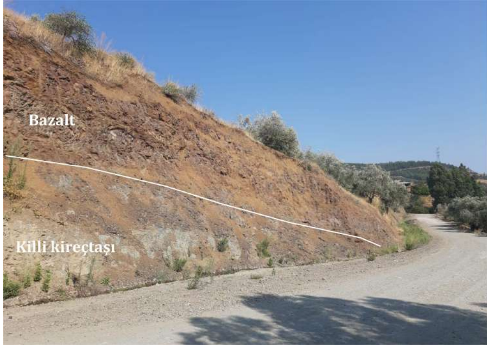
Şekil 4.10. Alıçlıgedik Tepenin güneybatısında yer alan yol yarmasında bazalt ve kireçtaşı sınırı. (DATUM: ED50 D.O.M:36 D.G:3- Y:515583.00 X:4027974.00).
