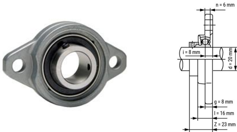
Şekil 4.22: KFL004 Rulman ve Ölçüleri
