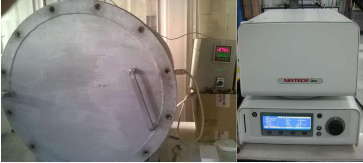
Şekil 3.4. Çalışmada kullanılan ısıtım fırınları
