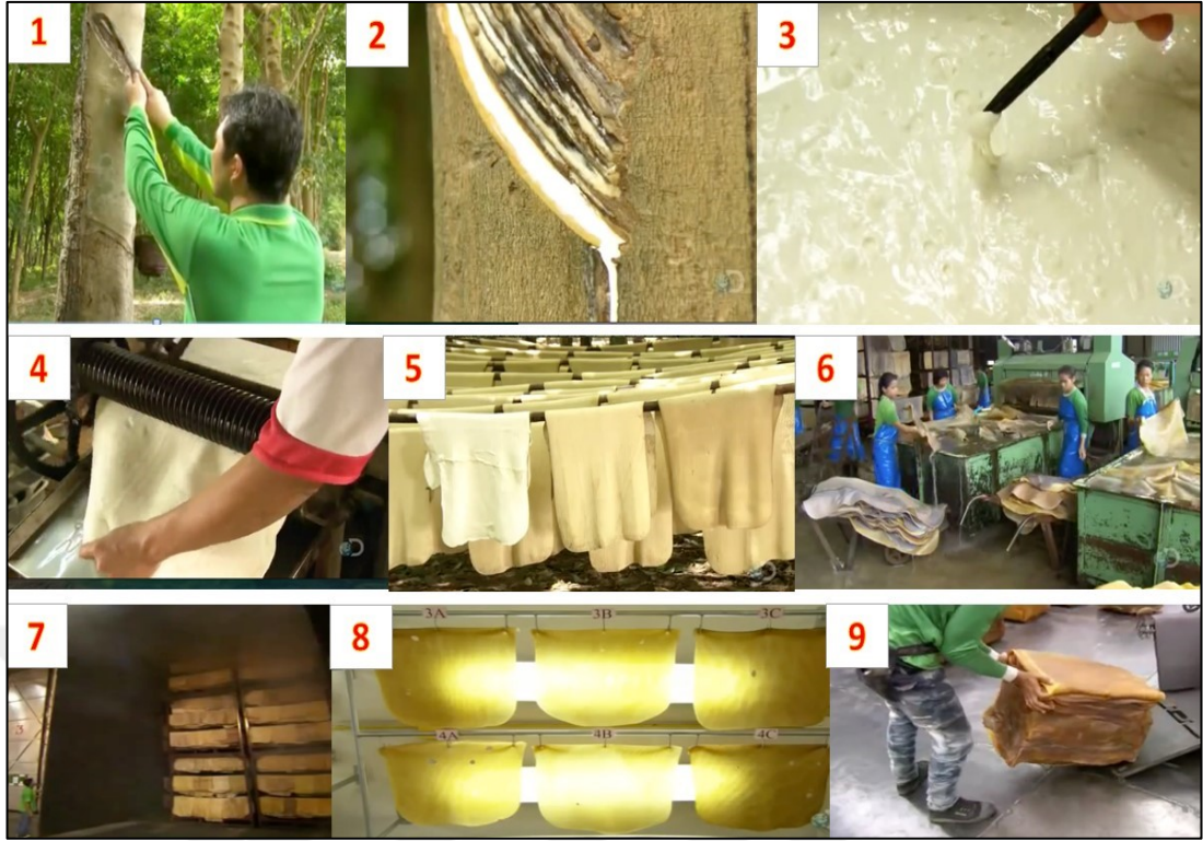
Şekil 1.4. Doğal Kauçuğun üretim aşamaları
