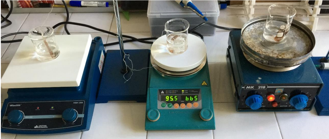
Şekil 13 Diyaliz tüpü tipi seçimi için kurulan deney düzeneği
