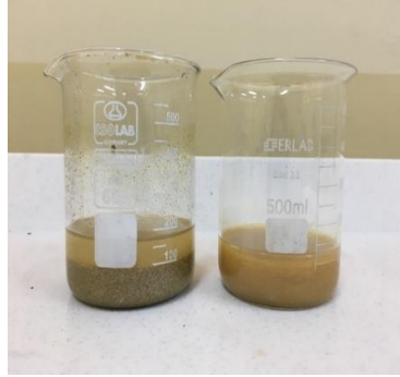
Şekil 2 Modifiye Hummers Metodu ile bağlanmış grafen oksitin çöktürülmesi
