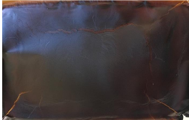
Şekil 3 Modifiye Hummers Metodu ile üretilen grafen oksitin etüvde kurutulması ile elde edilen film tabaka
