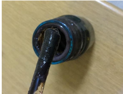
Şekil 1 Modifiye Hummers Metodu ile sentezlenen grafen oksitin ilk aşamada elde edilen görüntüsü
