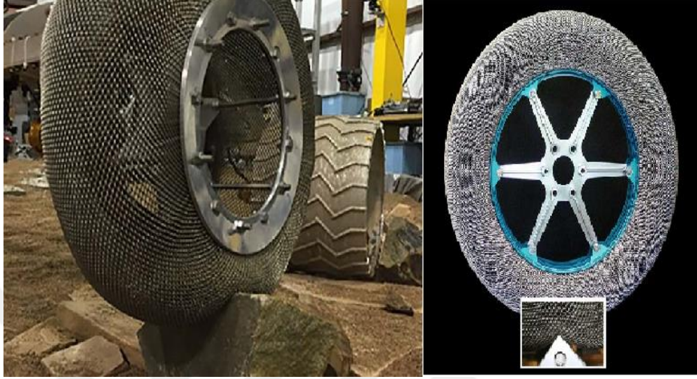
Şekil 2.19. NASA tarafından geliştirilen SMA yapıları esnek lastik [79].
