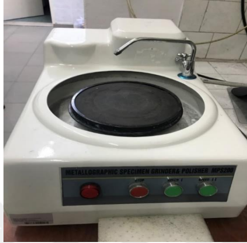
Şekil 3.4. Bu çalışmada kullanılan Polisher MPS200 marka zımparalama cihazı.
