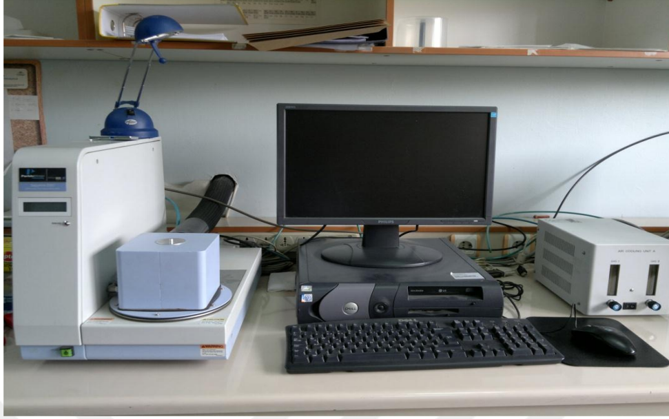
Şekil 3.7. Bu çalışmada kullanılan Perkin Elmer Sapphire (DSC) ölçüm cihazı
