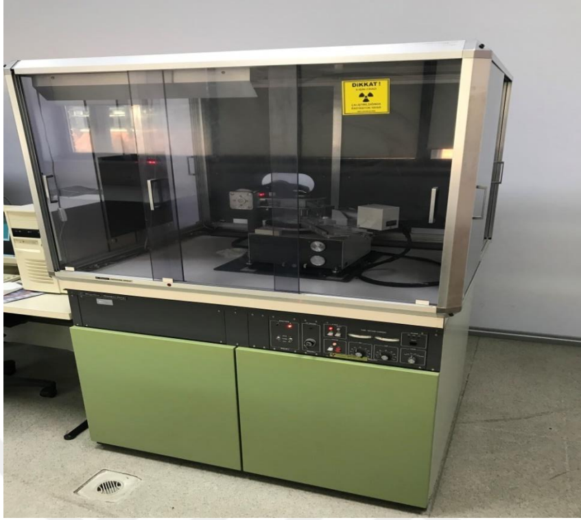
Şekil 3.8. Bu çalışmada kullanılan Bruker Discover D8 X-ray diffraction (XRD) analiz sistemi.
