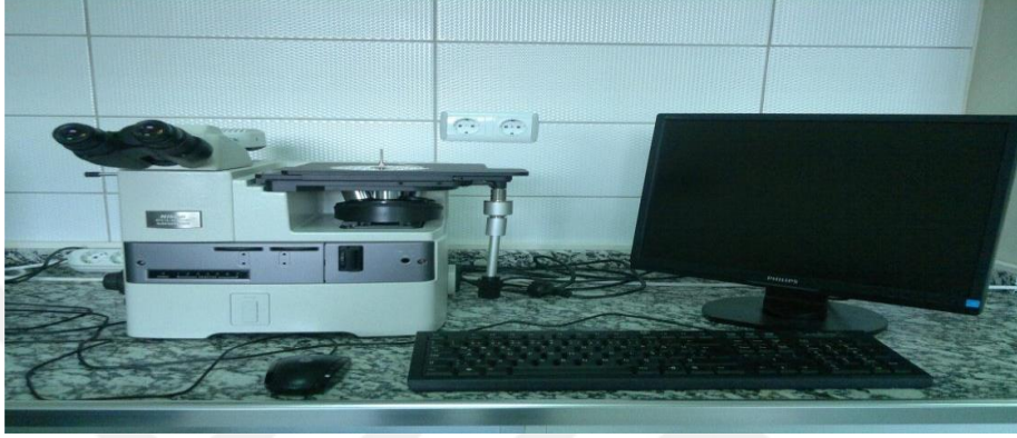
Şekil 3.5. Metalografik gözlemlerin yapıldığı Optik Nikon MA 200 Optik Fotoğraf cihazı.
