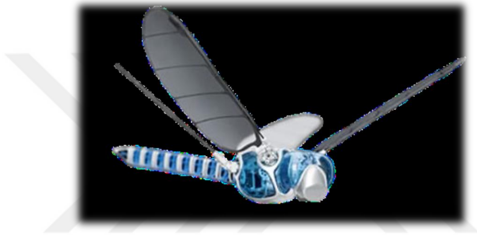
Şekil 2.20. Yusufçuk böceğinin uçuşu ilham alınarak Festo Biyonik Opter üretilmiş [87].
