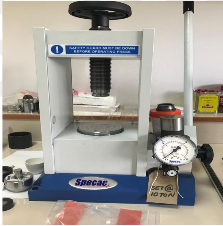
Şekil 3.1. Bu çalışmada kullanılan Graseby Specac marka presleme cihazı.
