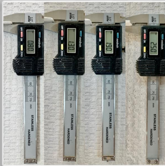
Resim 25. Zirkonya örneklerin sinterizasyon işlemi öncesi kalınlıkları a) 0.8 mm; b) 1.3 mm; c) 1.9 mm; d) 2.5 mm
