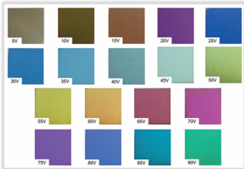
Şekil 4. Voltaj değişikliğine bağlı Ti6Al4V örneklerde oluşan renkler (0-90 V; 1 mmol/L H_3PO_4 ; 25°C-27°C; Süre=60 saniye)(126)
