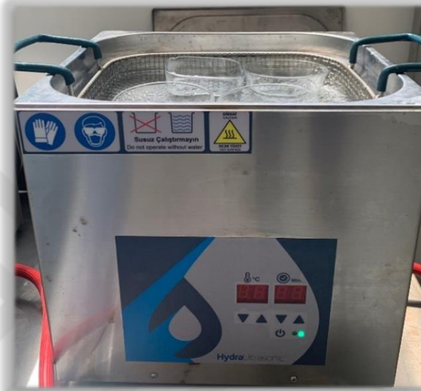
Resim 38. Renklendirme işlemi sonrasında yüzey bitirme işlemi için kullanılan ultrasonik cihaz
