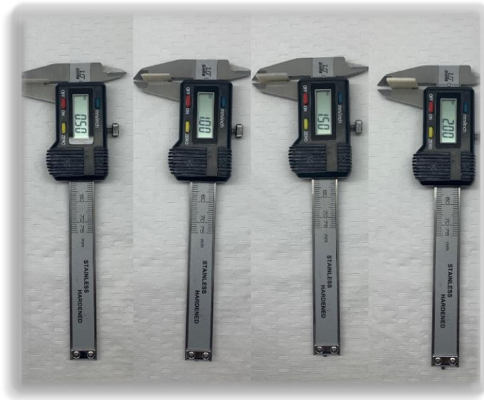
Resim 28. Sinterizasyon ve polisaj işlemleri sonrasında örnek kalınlıklarının dijital kumpas yardımıyla ölçülmesi
