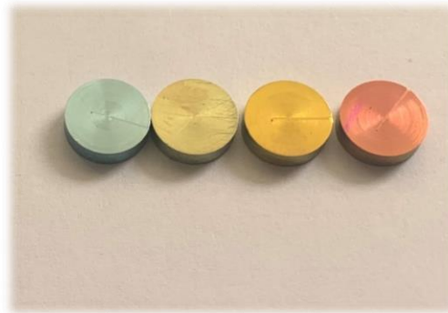
Resim 37. Renklendirme işlemi sonrası elde edilen anodize titanyum dayanıklar
