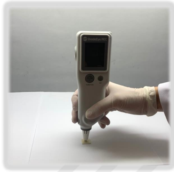
Resim 42. Monolitik zirkonyum örneklerin ilk renk ölçümlerinin yapılması
