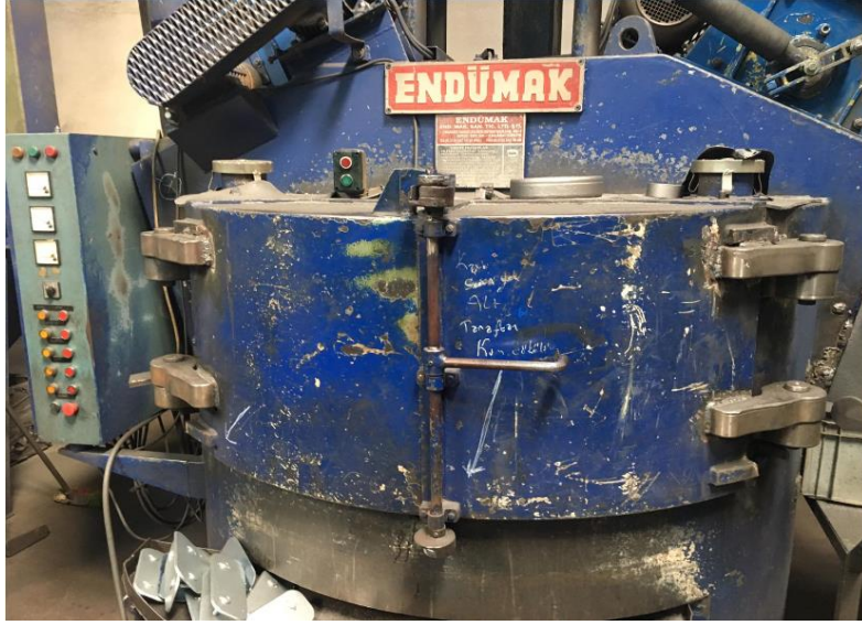
Şekil 2.14 Dış Borunun Kumlamasında Kullanılan Kumlama Makinesi.
