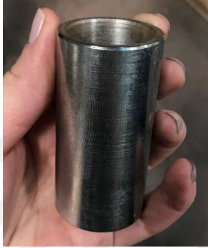
Şekil 2.4 Ø35/28X70 MM-ST37 (İç Boru).
