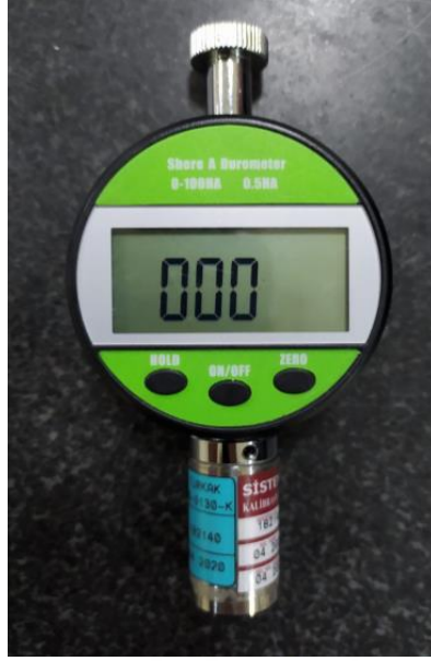
Şekil 2.10 Sertlik Ölçümünde Kullanılan Dijital Durometre
