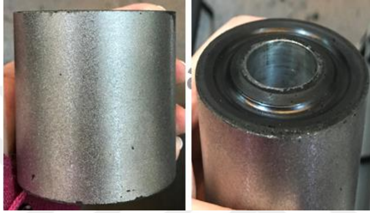
Şekil 2.24 Vulkanizasyonu Tamamlanmış Kauçuk – Metal Silindirik Kompozit Görseli.
