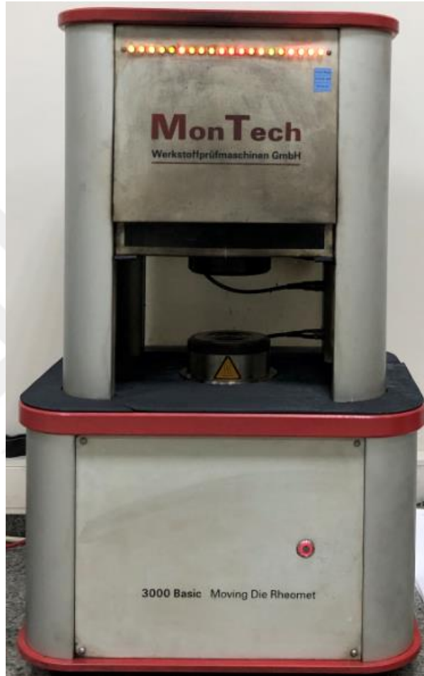
Şekil 2.1 MonTech 3000 Basic Rheometre Test Cihazı.
