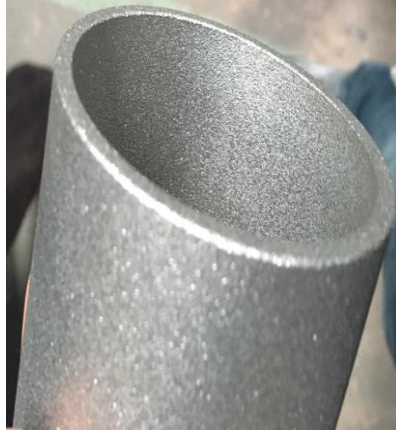
Şekil 2.16 Kumlanmış Dış Boru Metal Yarı Mamul Görseli.
