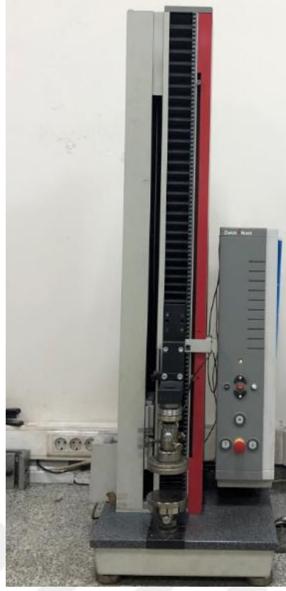
Şekil 2.2 Zwick Roel Üniversal Test Cihazı 2,5 kN.
