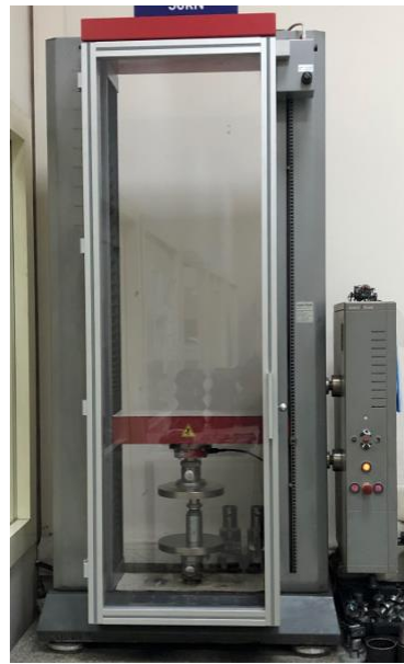
Şekil 2.3 Zwick Roel Üniversal Test Cihazı 50 kN.
