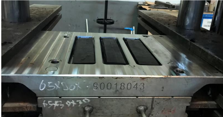
Şekil 2.23 Plaka Kauçuğun Transfer Haznesine Yerleştirilmesi.
