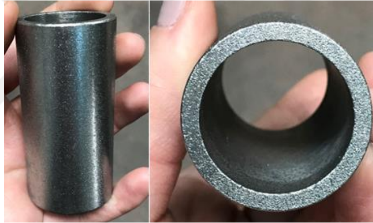
Şekil 2.13 Kumlanmış İç Boru Metal Yarı Mamul Görseli.
