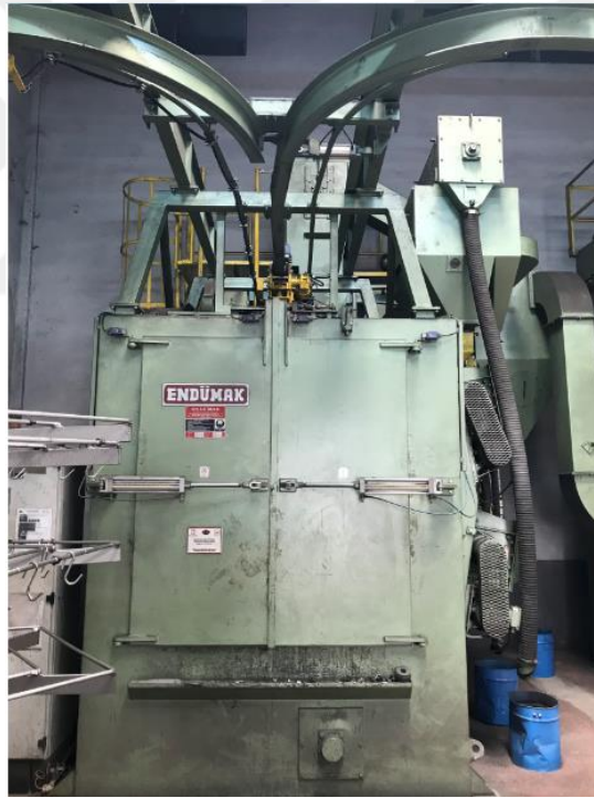
Şekil 2.11 İç Borunun Kumlamasında Kullanılan Kumlama Makinası.
