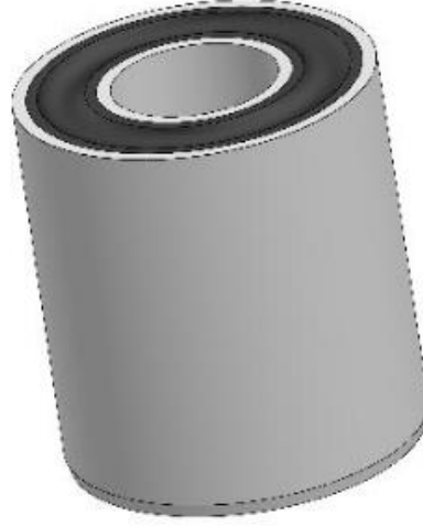
Şekil 2.6 Metal – Kauçuk Kompozit Silindirin İzometrik Görünüşü.
