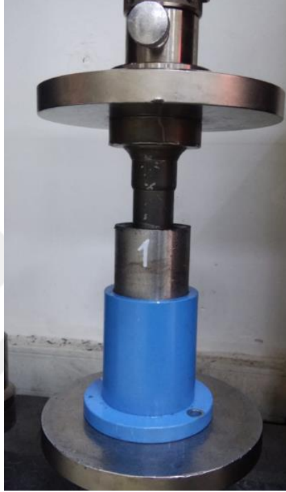
Şekil 2.25 Eksenel Test Aparatına Bağlanmış Ürün Görseli.
