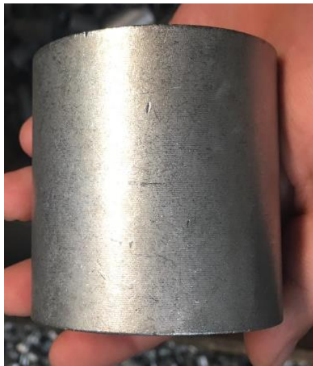
Şekil 2.5 Ø67/60X70 MM-ST37 (Dış Boru).
