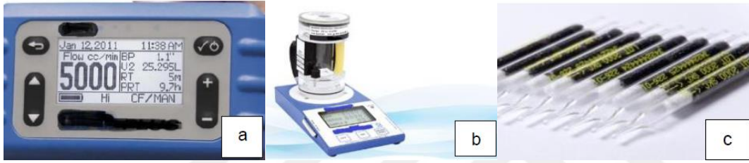
Şekil 2.2 : UOB örneklemede kullanılan cihaz ve malzemeler; Pompa (a), Kalibratör (b), Aktif karbon tüpleri (c).
