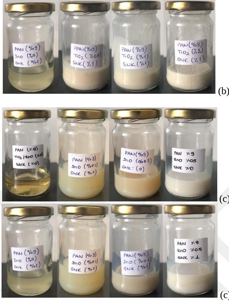
Şekil 3.2 : Saf PAN polimer çözeltisi (a), SNK-TiO 2 nanokatlı PAN polimer çözeltileri (b) ve SNK-ZnO nanokatlı PAN polimer çözeltileri (c).
