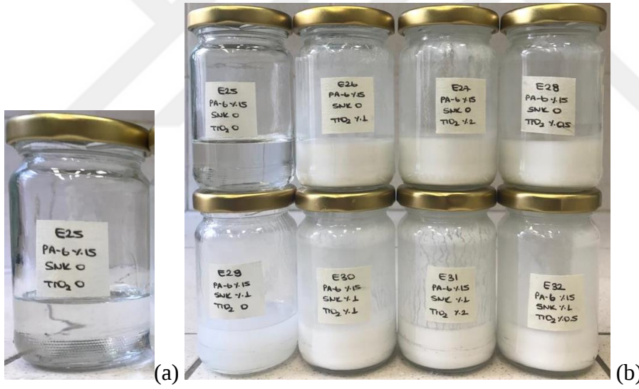
Şekil 3.4 : Saf PA6 polimer çözeltisi (a), SNK-TiO 2 nanokatıllı PA6 polimer çözeltileri (b).
