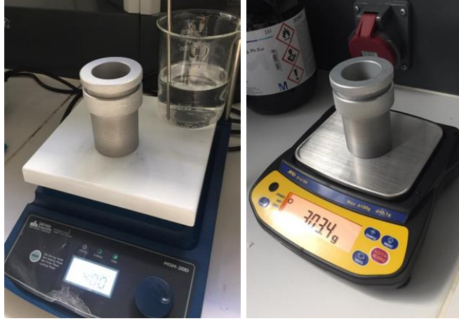
Şekil 3.10 : Su buharı geçişi test ekipmanı.
