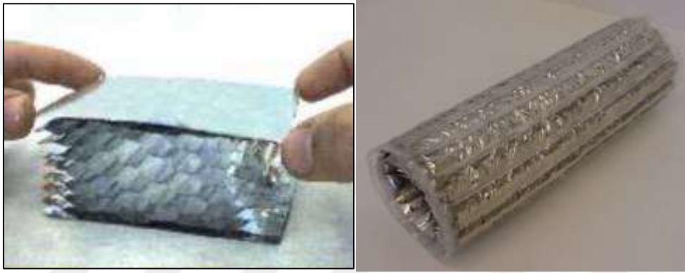
Şekil 79. Gaz dolgulu panel (GFP) örnekleri (Jelle vd., 2011)
