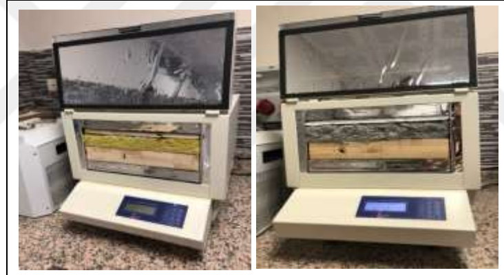
Şekil 81. Isıl iletkenlik ölçümü yapılan alternatif yalıtım malzemeleri örneği
