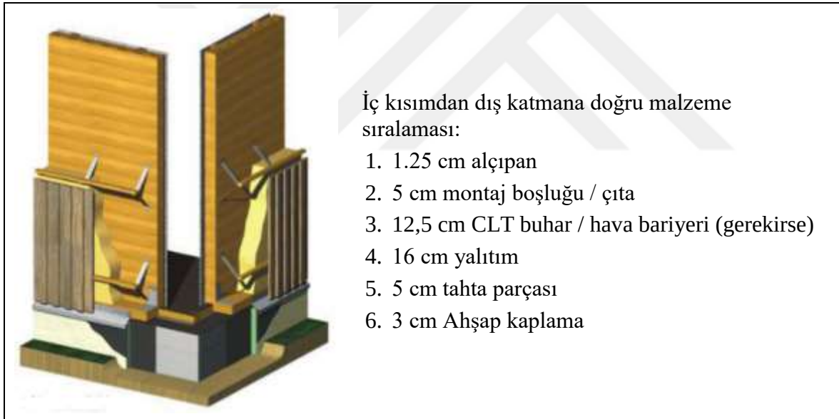
Şekil 59. CLT yalıtımlı dış duvar örneği (Ferk, 2013)
