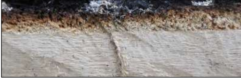
Şekil 30. CLT yangın anında üst yüzeyindeki kömürleşme (Store Enso, 2017)
