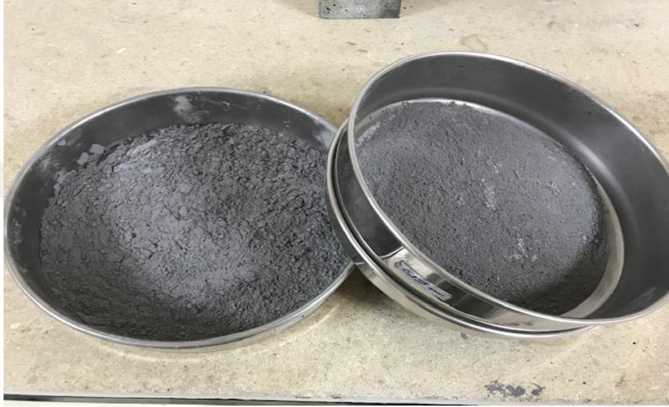
Şekil 2.2. Cüruf eleme işlemi
