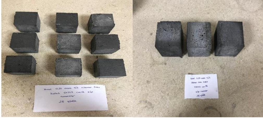
Şekil 2.10. Aktivatör/bağlayıcı oranı 0.35, 0.40 ve 0.45 olan % 5-% 10-% 15 mermer tozu katkılı % 0,5 cam lifi ilaveli 5*5*5 cm'lik küp ve 7*7*7 cm'lik küp numuneler
