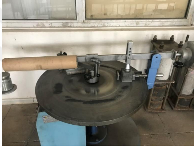
Şekil 2.13. Böhme aşınma cihazı
