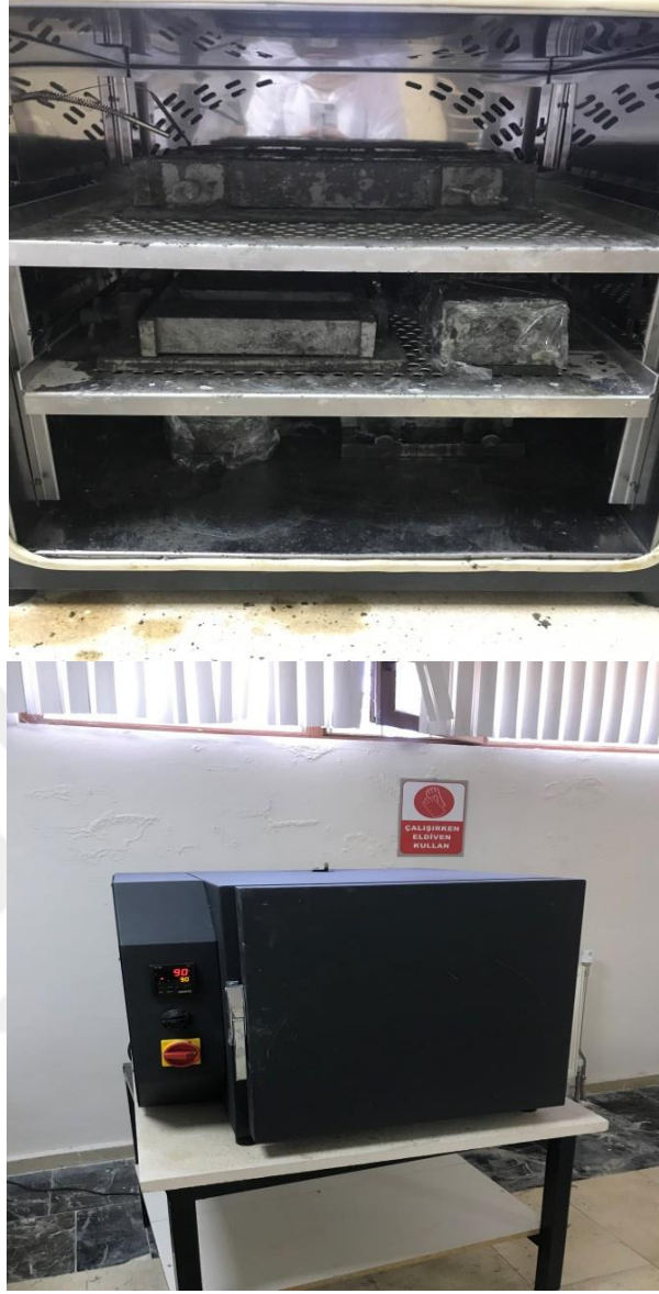
Şekil 2.9. Etüve atılarak 90°C de bekletilen numuneler
