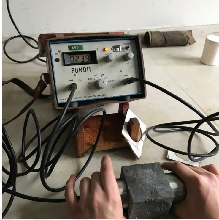
Şekil 2.15. Ultrases geçiş hızı deneyi
