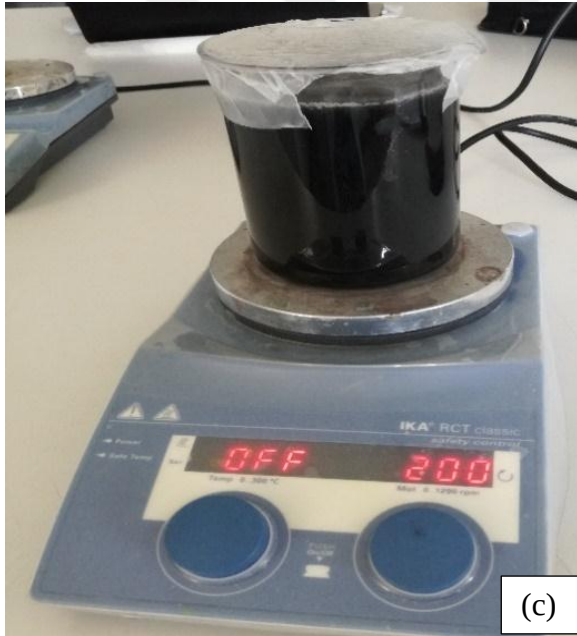
Şekil 3.3. Katalizörün indirgenme görüntüleri a) \text{NaBH}_4 çözeltisinin manyetik karıştırıcıda hazırlanması b) Aktif karbon destekli katalizör ile \text{NaBH}_4 çözeltisinin birleştirilmesi ve gaz kabarcıklarının gözlemlenmesi c) İndirgenme için aktif karbon destekli katalizör ile \text{NaBH}_4 çözeltisinin karıştırılması d) Aktif karbon destekli katalizörün indirgenmesi ve faz ayrımı
