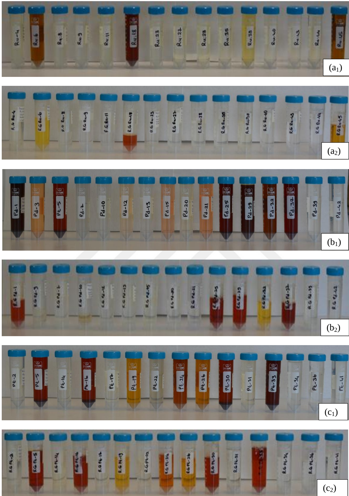
Şekil 4.12. Hidrojenizasyondan elde edilen ham ve rafine sıvının renk değerleri üzerine farklı katalizör, sıcaklık, basınç, süre ve reçine uygulamasını gösteren fotoğraflar a) Rutenyum b) Paladyum c) Platin 1- Ham sıvı 2- Rafine sıvı
