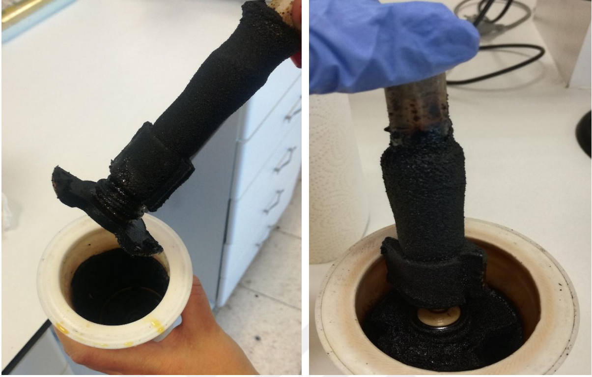
Şekil 4.13. 200°C sıcaklıkta ve paladyum ve platin katalizörleri varlığında yapılan denemelerde sıcaklığa bağlı olarak reaksiyon kabı çeperine yapışan karamelizasyon ve karbonizasyon ürünlerini gösteren görüntüler
