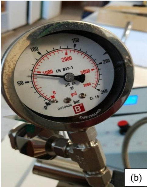
Şekil 3.5. Reaktör ve çevre birimlerinin genel görünümü a) Reaktör ve çevre birimleri b) H 2 gazı basınç göstergesi c) H 2 gazı tüpü
