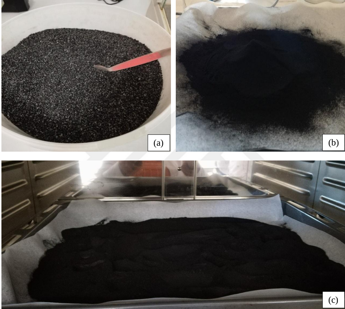
Şekil 3.1. Katalizör destek materyali olarak kullanılan aktif karbonun hazırlanma görüntüleri a) İri granüler aktif karbon b) Öğütülmüş aktif karbon c) Öğütülmüş ve kurutulmuş aktif karbon
