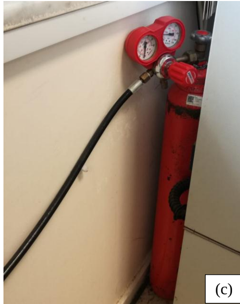
Şekil 3.5. Reaktör ve çevre birimlerinin genel görünümü a) Reaktör ve çevre birimleri b) H 2 gazı basınç göstergesi c) H 2 gazı tüpü
