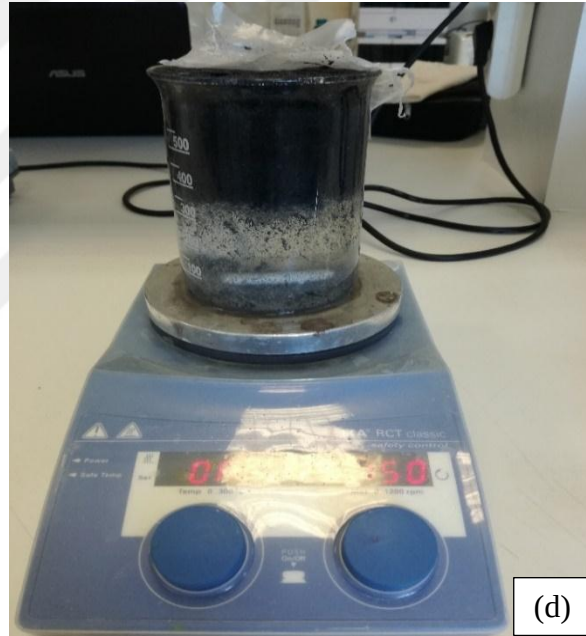
Şekil 3.3. Katalizörün indirgenme görüntüleri a) \text{NaBH}_4 çözeltisinin manyetik karıştırıcıda hazırlanması b) Aktif karbon destekli katalizör ile \text{NaBH}_4 çözeltisinin birleştirilmesi ve gaz kabarcıklarının gözlemlenmesi c) İndirgenme için aktif karbon destekli katalizör ile \text{NaBH}_4 çözeltisinin karıştırılması d) Aktif karbon destekli katalizörün indirgenmesi ve faz ayrımı
