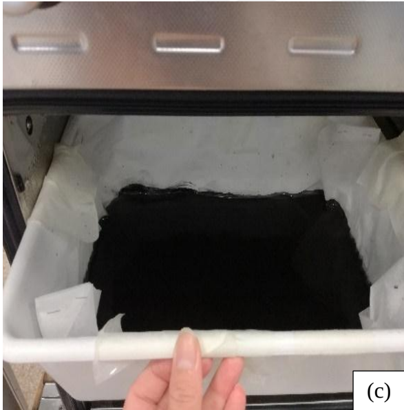
Şekil 3.2. Aktif karbon destekli katalizörün hazırlanması a) Islak impregnasyon yöntemi için aktif karbon ve katalizörün birleştirilmesi b) Aktif karbon destekli katalizörün filtrasyonu c-d) Vakum kurutma
