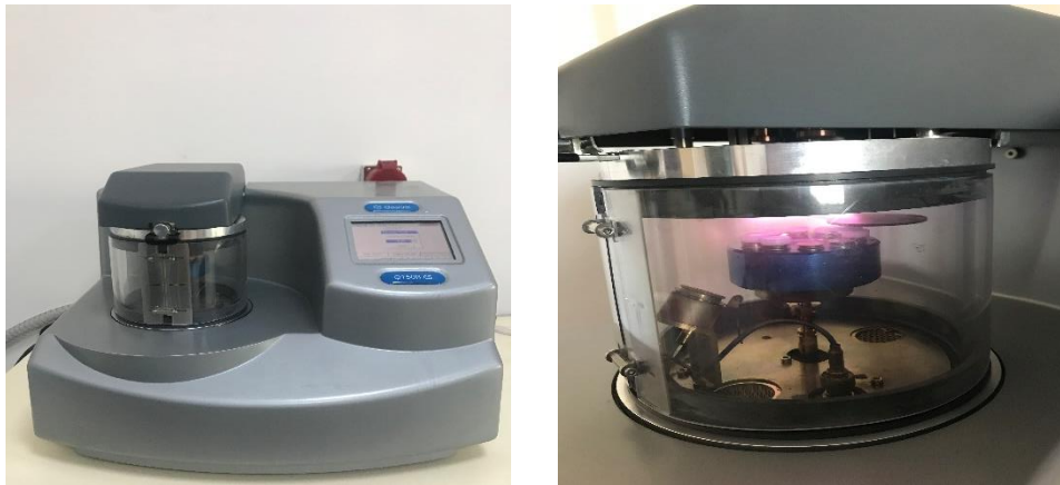
Şekil 3.12. Altın kaplama cihazı ve örneklerin SEM'de incelenmek için altın kaplanması
