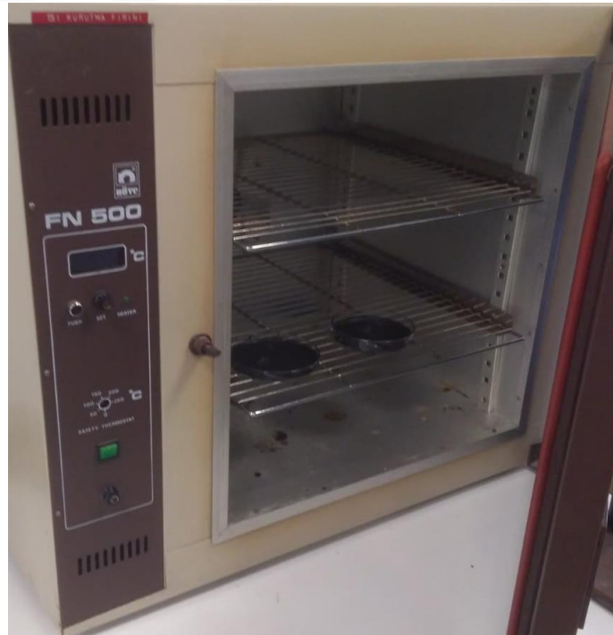
Şekil 6.2: Grafen Oksitin Fırında Kurutulması
