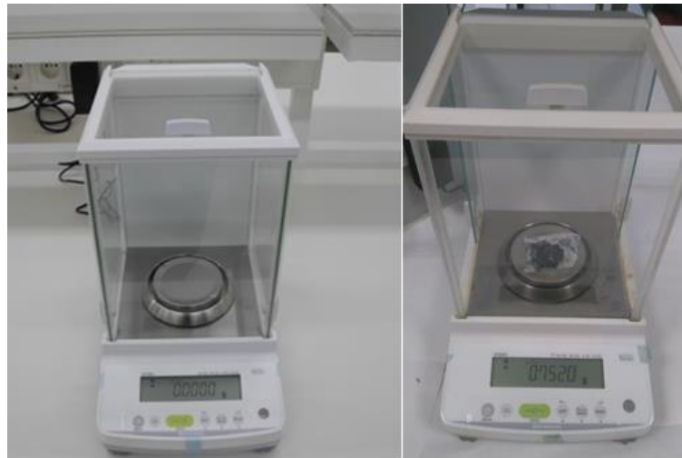
Şekil 6.5: 1 \times 10^{-4} g Hassasiyette Ölçüm Terazisi
