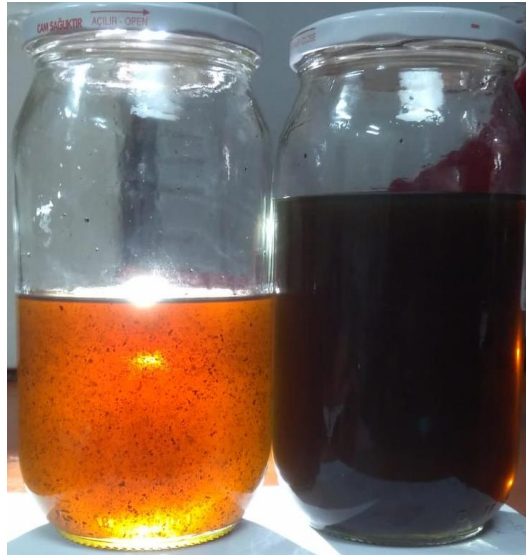
Şekil 6.7: Ultrasonik Karıştırmadan Önce ve Sonra Grafen Oksit Katkılı Motor Yağının Görüntüleri
