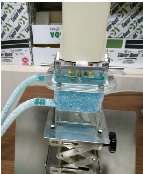
Şekil 6.13: Soğutucu Akışkanın -17 °C Olduğu Durum
