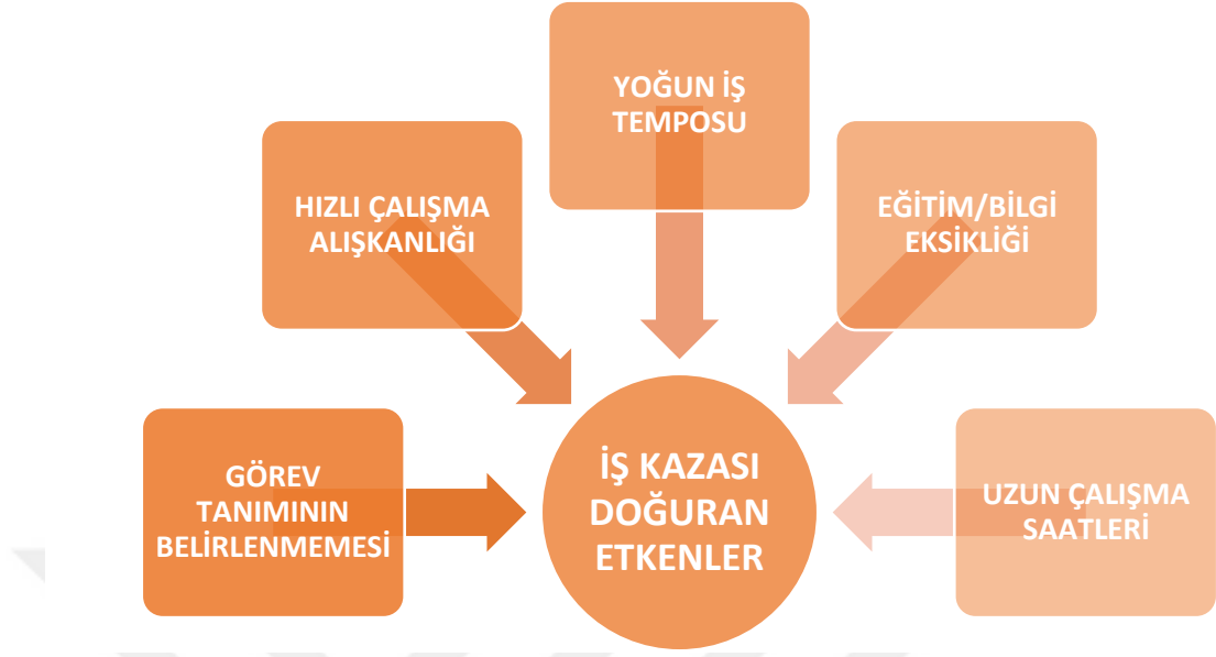
Şekil 4.18: Katı Atık Tesisinde Tespit Edilen, İş Kazası Doğuran Etkenler
