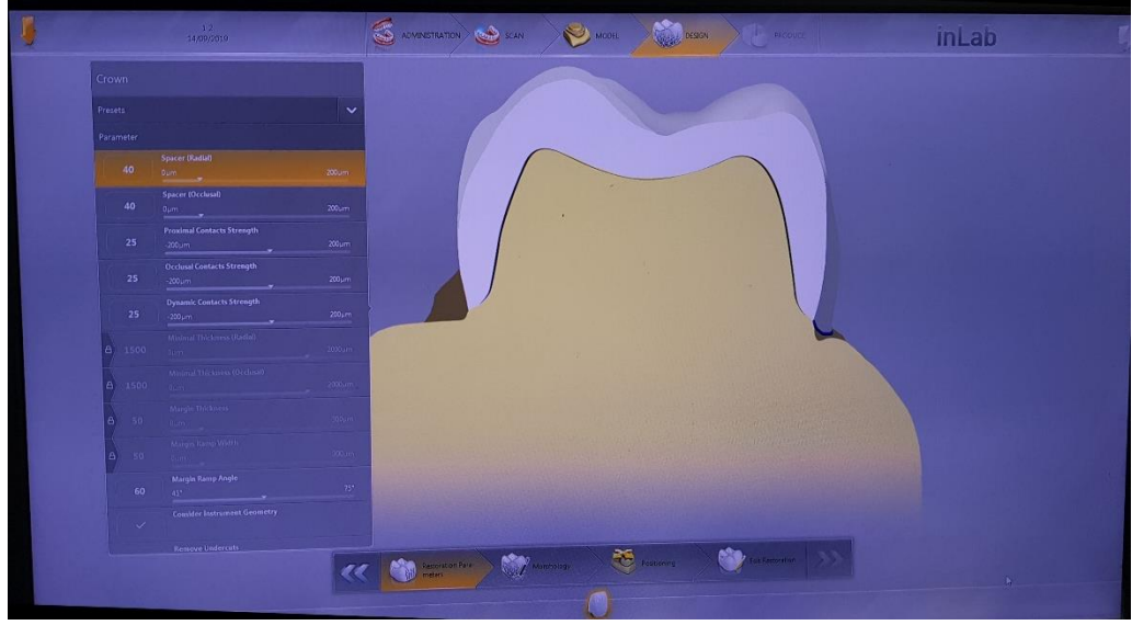
Resim 7: Sirona InLab yazılımı kullanılarak internal ve marjinal siman boşluğunun tanımlanması
