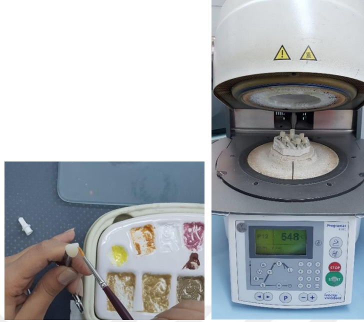
Resim 11: Kristalizasyonu tamamlanmış kronlara glazür uygulaması ve Programat P300 porselen fırınında bitim fırınlamasının yapılması
