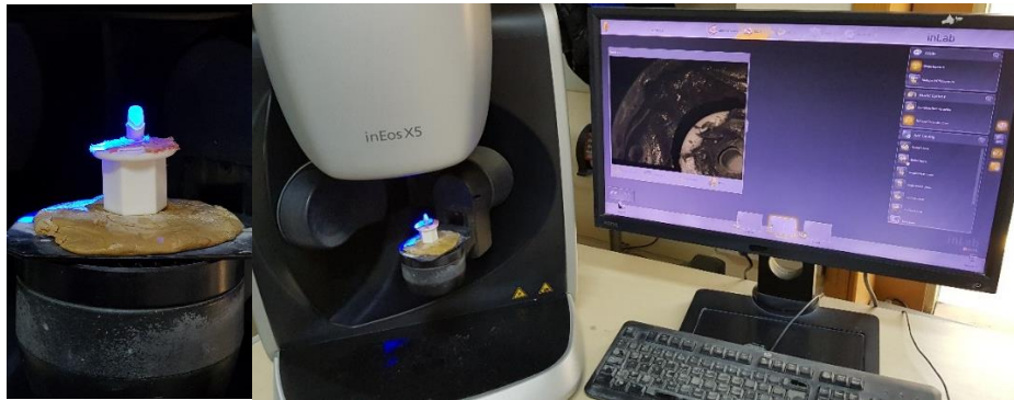
Resim 4: İndirekt Dijitalizasyon grubu epoksi modellerin InEosX5 laboratuvar tarayıcısında taranması
