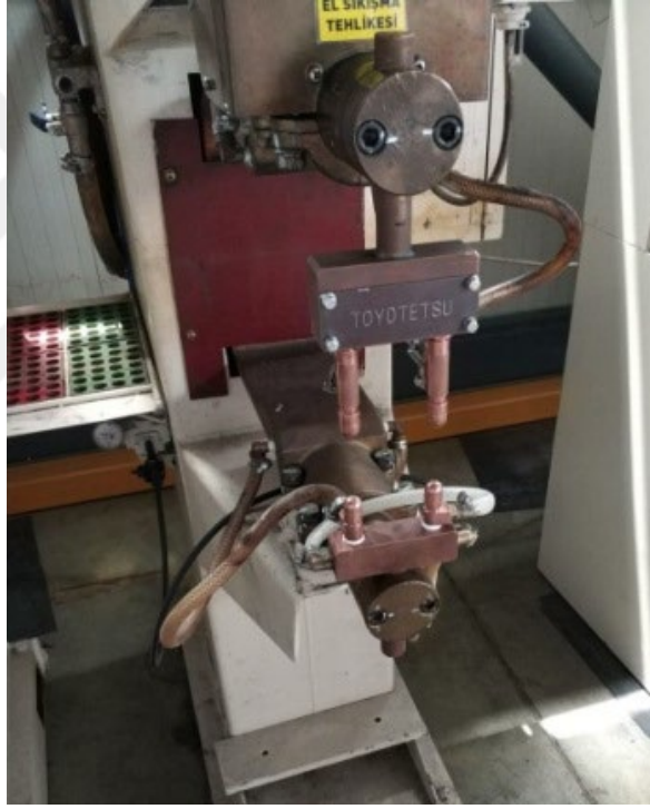
Şekil 4.1: Çoklu nokta elektrodunun sabit nokta kaynağı makinesine montajı.
