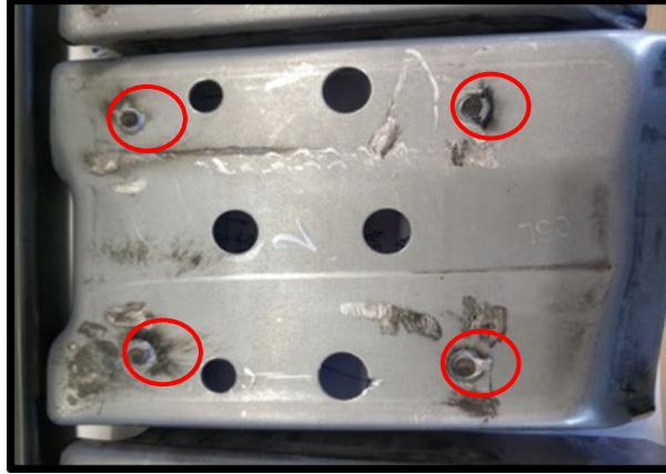
Şekil 4.6: Tahribatlı muayene yapılmış iş parçası.
