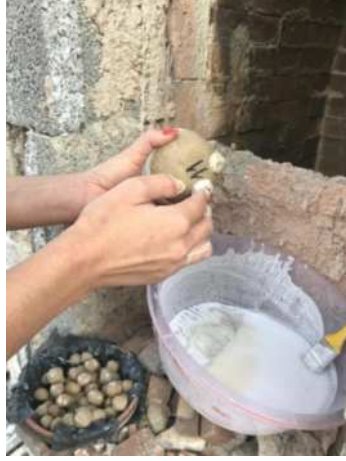
Görsel 66: Şamottan Yapılan Topları Almina ile Hazırlama Aşaması
