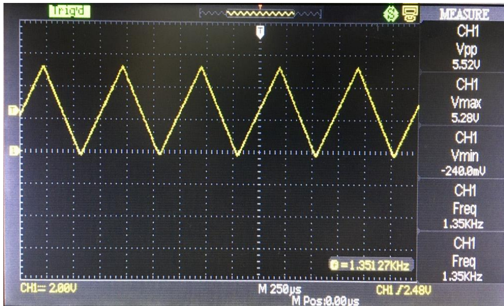
Şekil 4.22 Toplama devresi sonrası üçgen dalga sinyali
