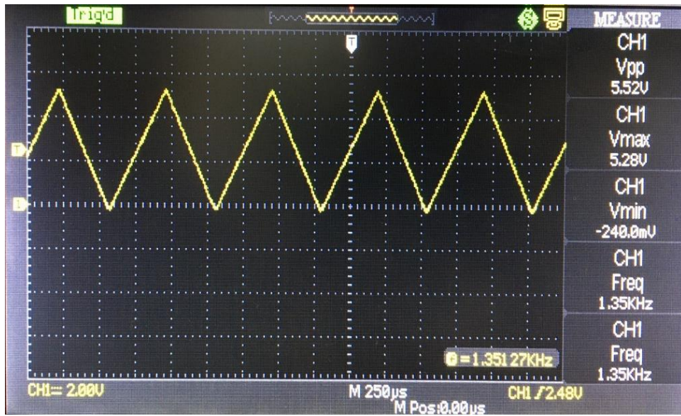
Şekil 4.16 Üçgen dalga üretici çıkış sinyali
