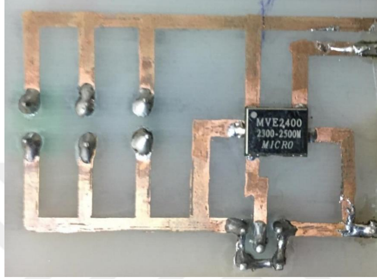
Şekil 4.5 Gerilim kontrollü osilatör baskı devresi ön yüzü
