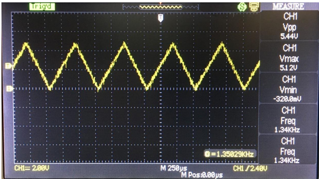
Şekil 4.26 Gürültü sinyali eklenmiş üçgen dalga sinyali
