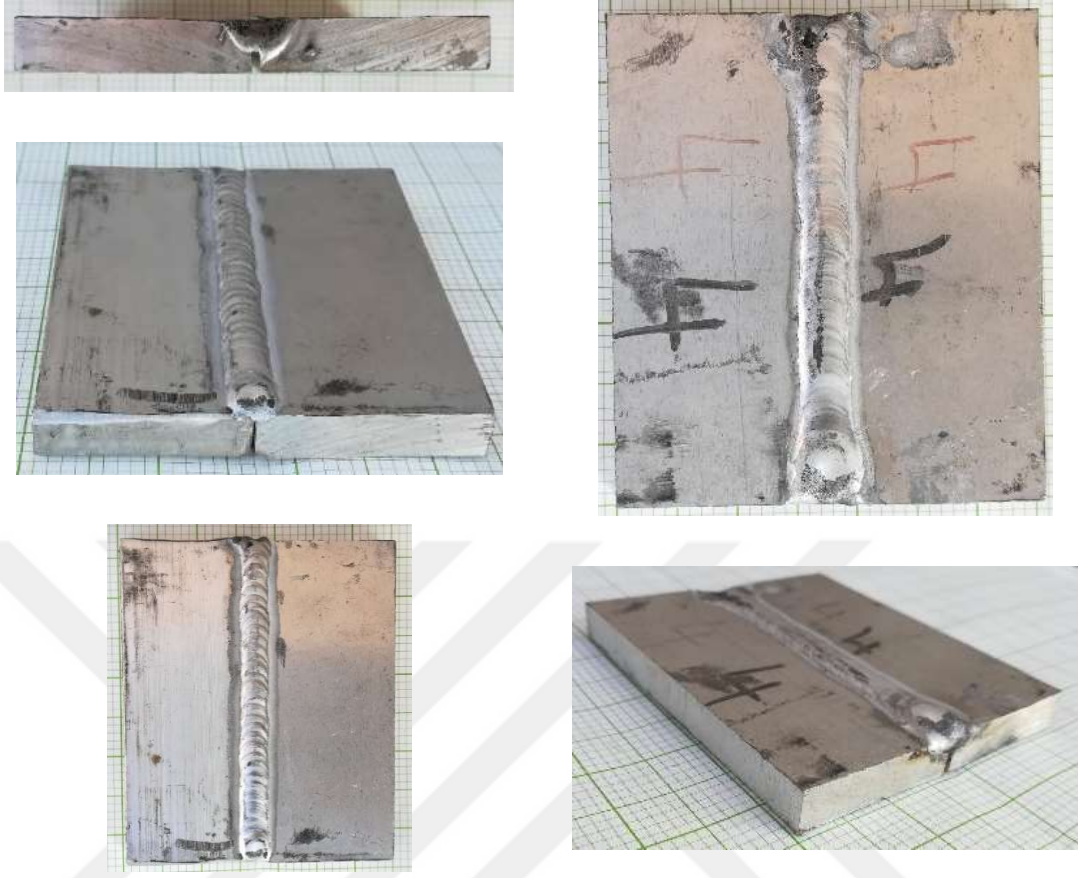
Şekil 4.6. A3 ve A4 parçalarının kaynak işlemi yapılmış hali.
