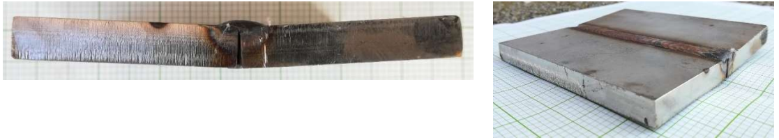
Şekil 4.5. A2 parçasının kaynak işlemi yapılmış hali.
