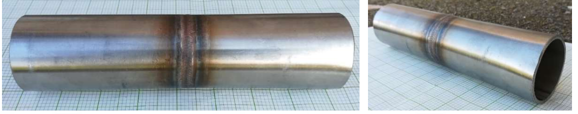
Şekil 4.3. B1 parçasının kaynak işlemi yapılmış hali.
