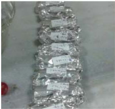
Şekil 4.15. Numunelerin alüminyum folyoya sarılması ve kapta bekletilmesi
