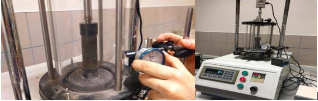
Şekil 4.14. Hazırlanan zemin numunesinin serbest basınç deneyi uygulaması
