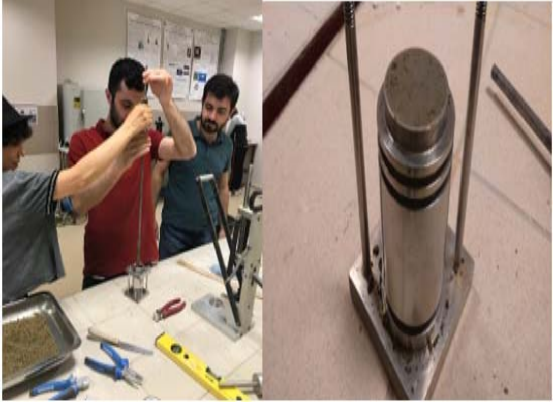
Şekil 4.9. Minyatür Proktor Aleti ile Numunenin Hazırlanması
