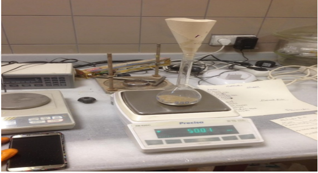
Şekil 3.7. Piknometre şişesi ve deney uygulaması
