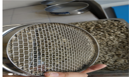
Şekil 3.6. Yıkamalı elek analizinde elek açıklığı ve elek düzeneği.
