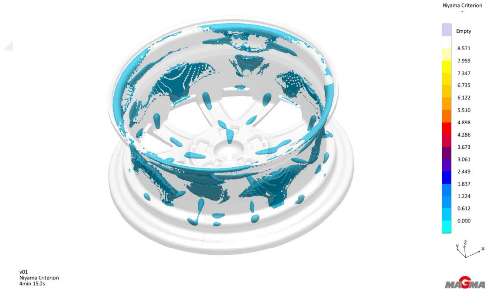
Şekil 3.29. Eski jant ayar kartı ile yapılan analiz katılaşma niyama kriteri sonucu
