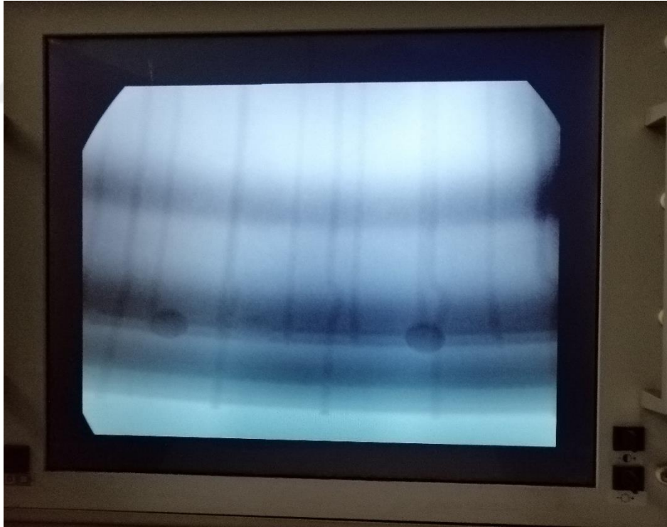
Şekil 4.6. Yeni jant ayar kartı ile döküm 8. jant X-ray kontrolü
