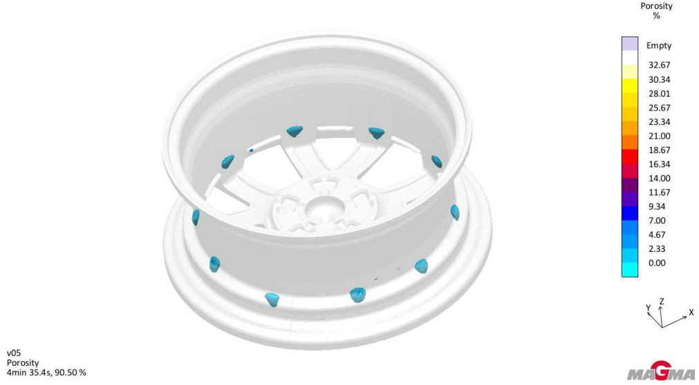
Şekil 3.50. Yeni jant ayar kartı katılaşma porozite sonucu
