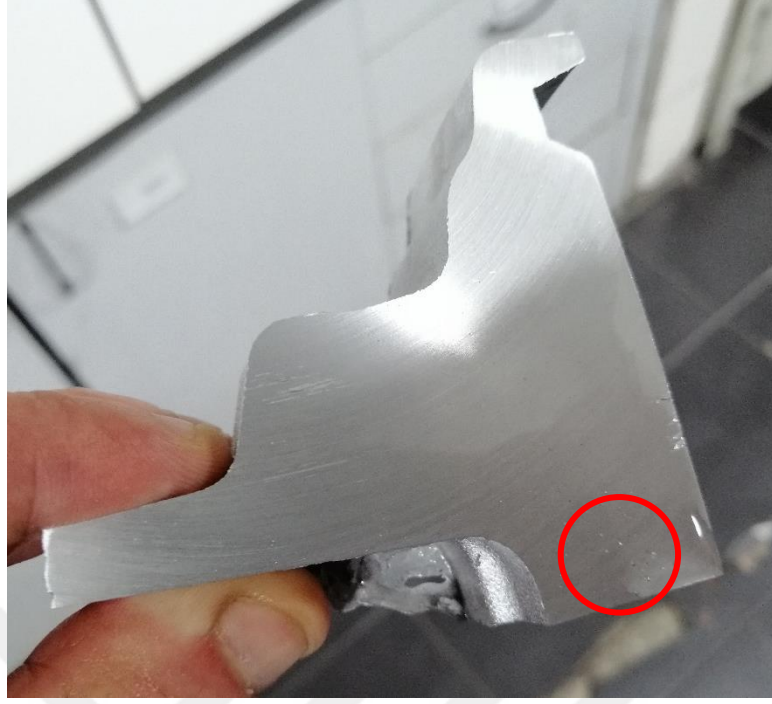
Şekil 4.7. Yeni jant ayar kartı ile döküm 8. jant kanat-rim profili arası kesit kontrolü
