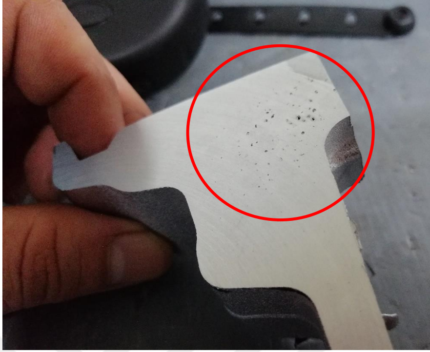
Şekil 4.3. Eski jant ayar kartı ile döküm 8. jant kesit kontrolü
