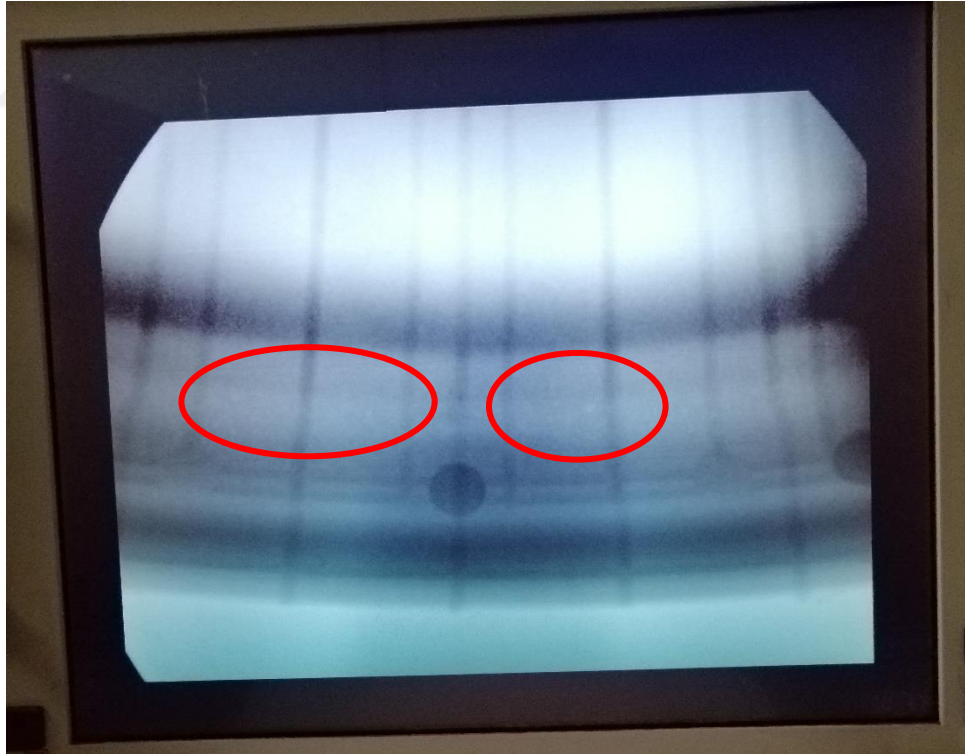
Şekil 4.2. Eski jant ayar kartı ile döküm 8. jant X-ray kontrolü
