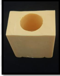
Şekil 3.20. Akrilik rezine gömme işleminde kullanılan kalıp
