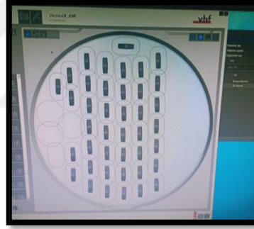
Şekil 3.4. PEEK ve PEKK malzemelerin dizayn yapıldıktan sonra kesim şeması
