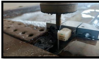
Şekil 3.8. Su Jet cihazıyla örneklerin hazırlanması
