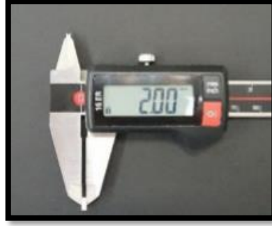
Şekil 3.6. Örnek boyutlarının kalınlık ölçer ile ölçülmesi
