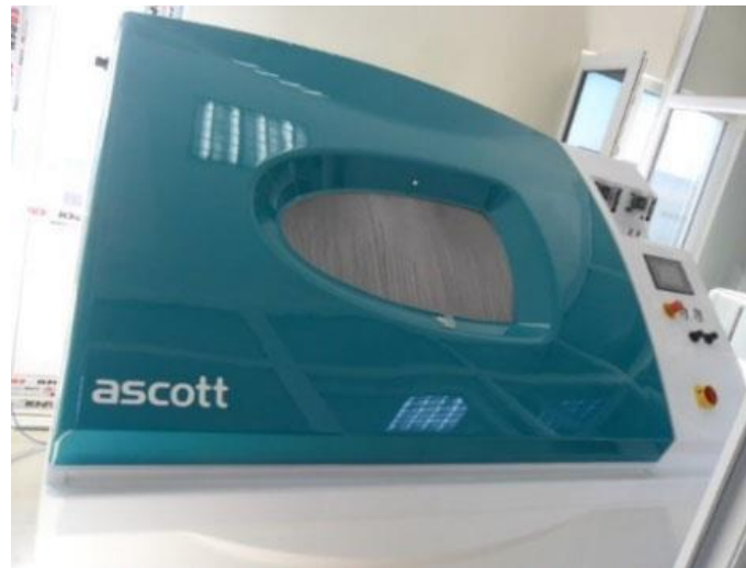
Şekil 8.5 : ASCOTT çevrimsel korozyon test kabini.
