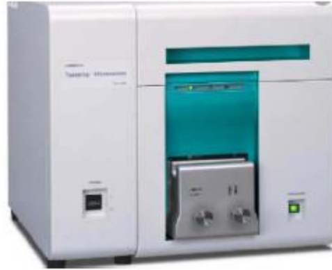
Şekil 8.1 : HITACHI TM-1000 SEM cihazı.
