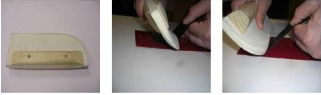
Şekil 8.3 : Yapışma bandı uygulaması.
