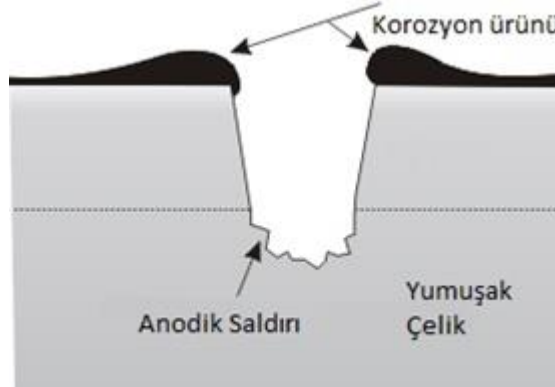
Şekil 3.1 : Yumuşak çelik yüzeyinde korozyon oluşumu [20].
