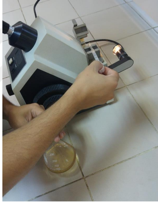
Şekil 3.15 SÇKM miktarının Leica Abbe Refraktometre ile ölçümü
