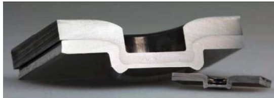
Şekil 2.8. 6+4 mm ve 1+1 mm sacların form punta kesiti (Israel ve ark. 2013’ten alınmıştır)
